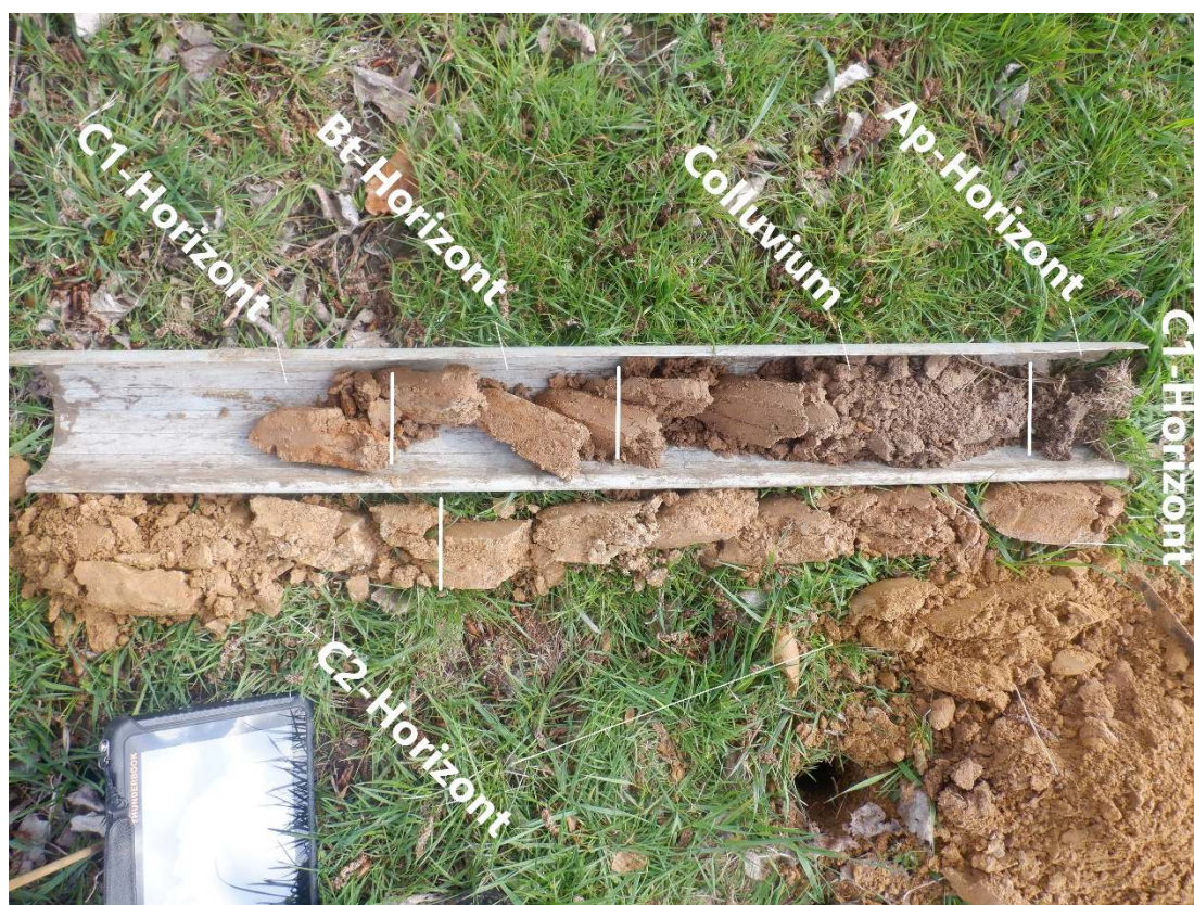
Afbeelding 8.2: Boring 1 met aanduiding van de verschillende horizonten.
