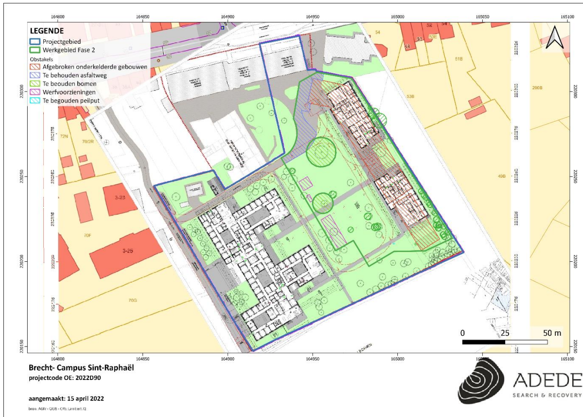
Figuur 25. Plan met geplande werken en indicatie van aanwezige obstakels.
