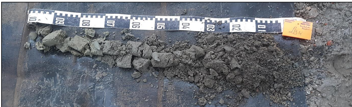
Figuur 10: Boring 4 van 0 (rechts) tot 100 cm (links) onder het maaiveld.
