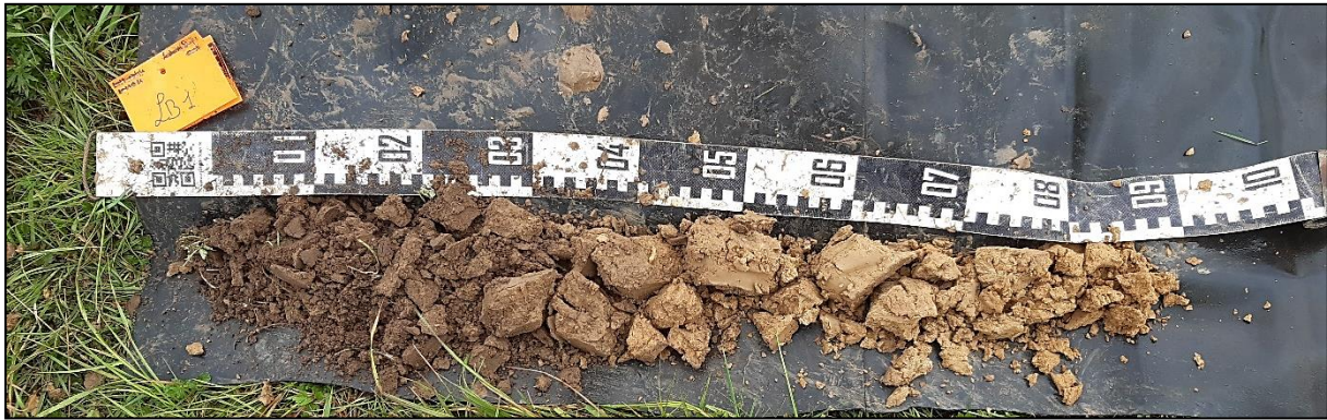
Figuur 8: Boring 1 van 0 (links) tot 90 cm (rechts) onder het maaiveld.
