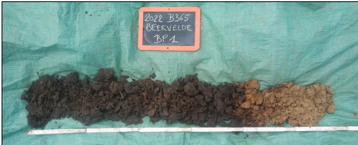
Figuur 6 Zicht op boorsequentie 1 met A-verstoring-C profiel.
