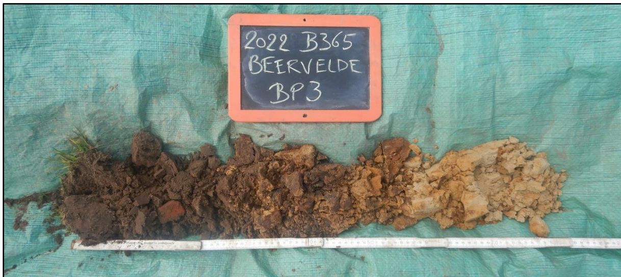
Figuur 7 Zicht op boorsequentie 3 met A-AC-C profiel.
