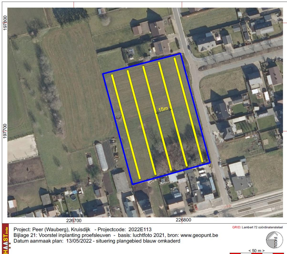
Fig. 21: voorstel van inplanting van de proefsleuven
