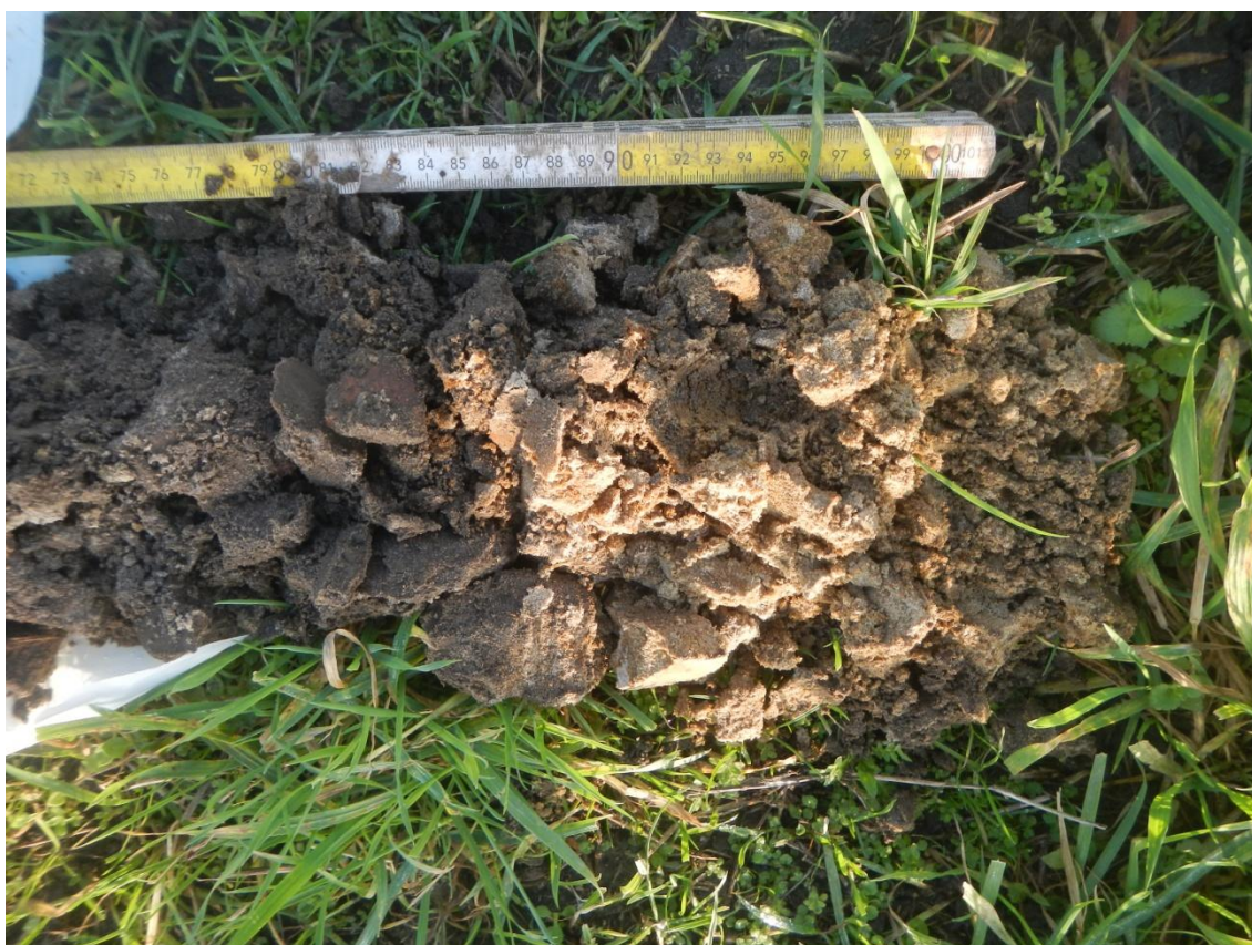
Figuur 37 Detail onderkant boring 2, overgang naar moedermateriaal.
