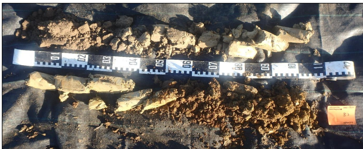
Figuur 29: Foto van boring 3 van 0 (linksboven) tot 200 cm (rechtsonder) beneden het maaiveld.
