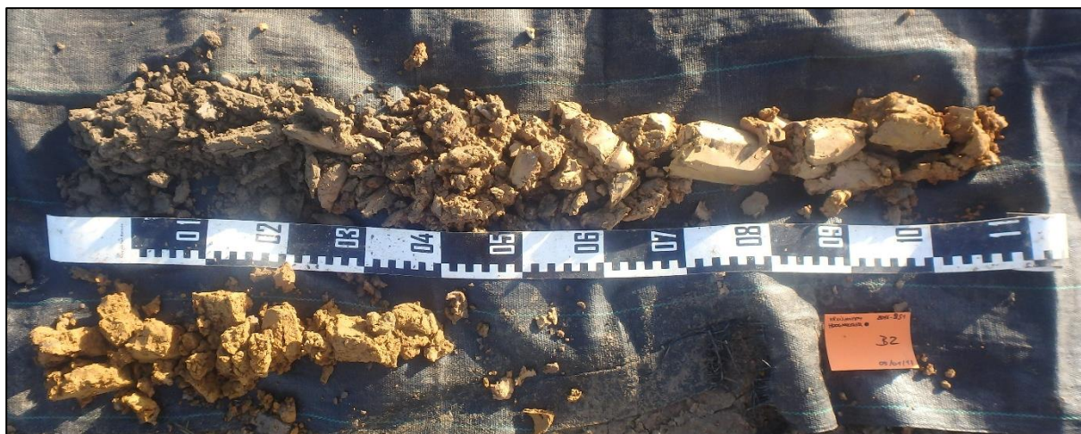
Figuur 28: Foto van boring 2 van 0 (linksboven) tot 140 cm (rechtsonder) beneden het maaiveld.
