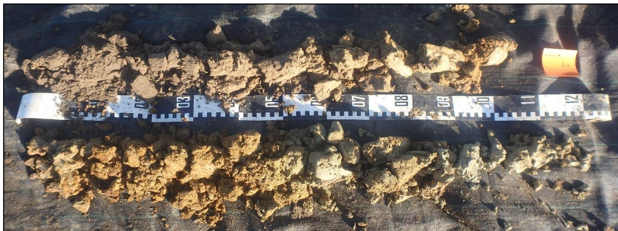
Figuur 30: Foto van boring 4 van 0 (linksboven) tot 220 cm (rechtsonder) beneden het maaiveld.
