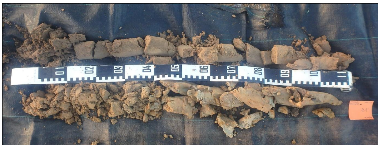
Figuur 27: Foto van boring 1 van 0 (linksboven) tot 200 cm (rechtsonder) beneden het maaiveld.
