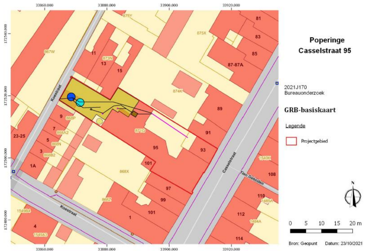
Figuur 7: Vereenvoudigde weergave van de geplande werken. Legende: Geel: nieuwbouw, blauw: regenwaterput, lichtblauw: infiltratieput, bruin: vetvanger, zwart: riolering, paars: bestaande riolering en afvoerputjes (bron: geopunt)
