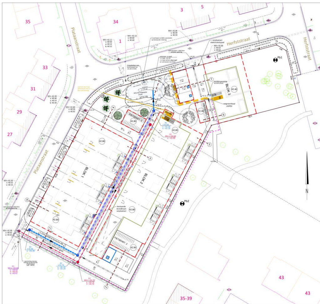
Afb. 10. Overzicht van de geplande rioleringen. (Bron: Opdrachtgever)
