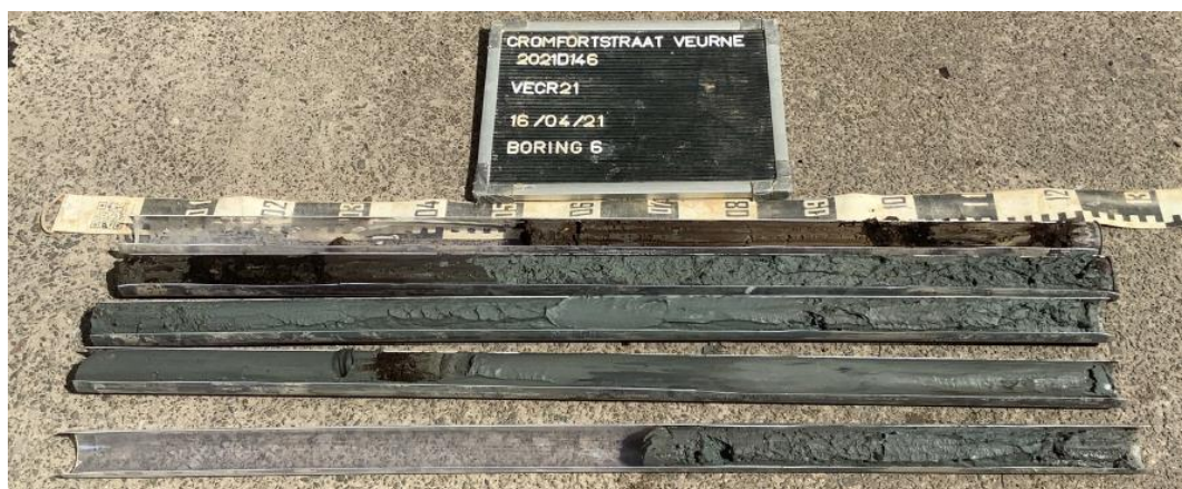
Figuur 11: Boring B6 (Bron: Geosonda NV).
