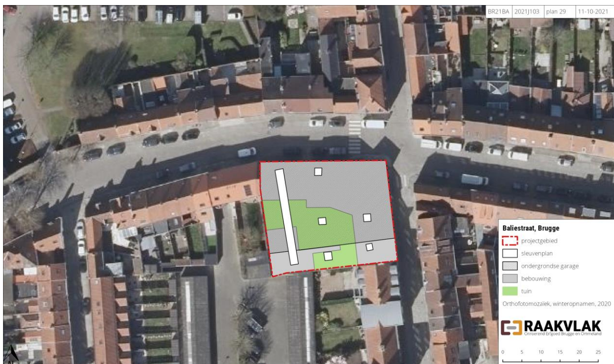
Figuur 4: Het sleuvenplan ten opzichte van de geplande werken
