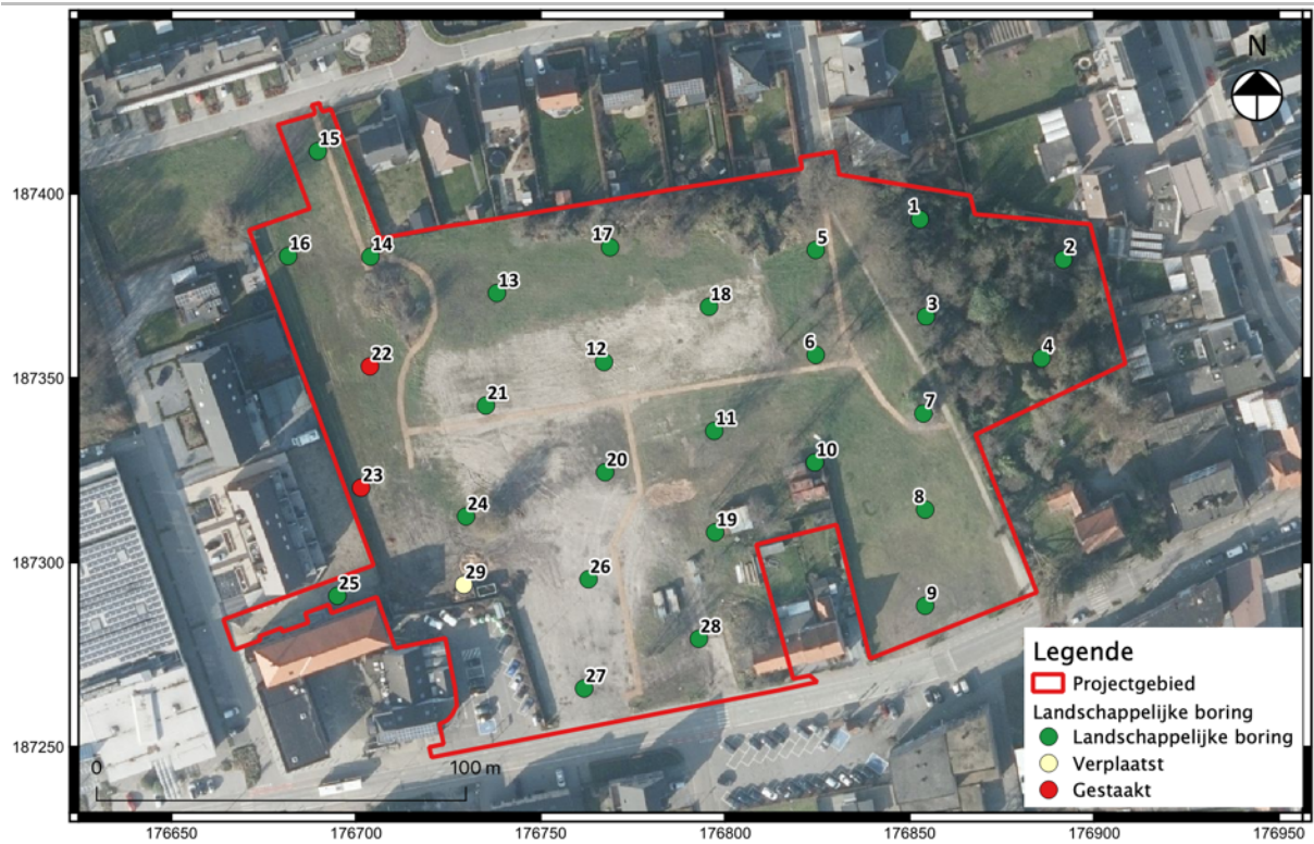
Fig.2.2: Het uitgevoerde boorpuntenplan met aanduiding van de gestaakte en verplaatste boringen.
