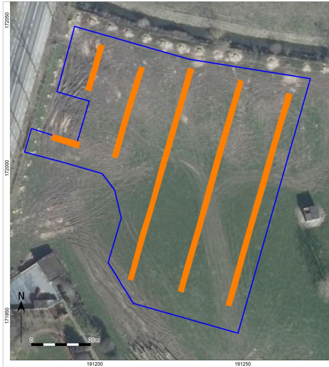
Afb. 2. Overzicht van de aangelegde proefsleuven.
