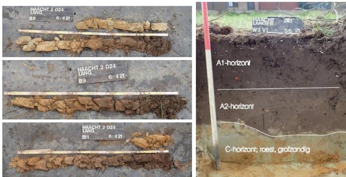
Figuur 18 Zicht op de landschappelijke boorsequenties en bodemprofiel aan de Langerheide/Zoellaan (bron: Verrijckt 2021).
