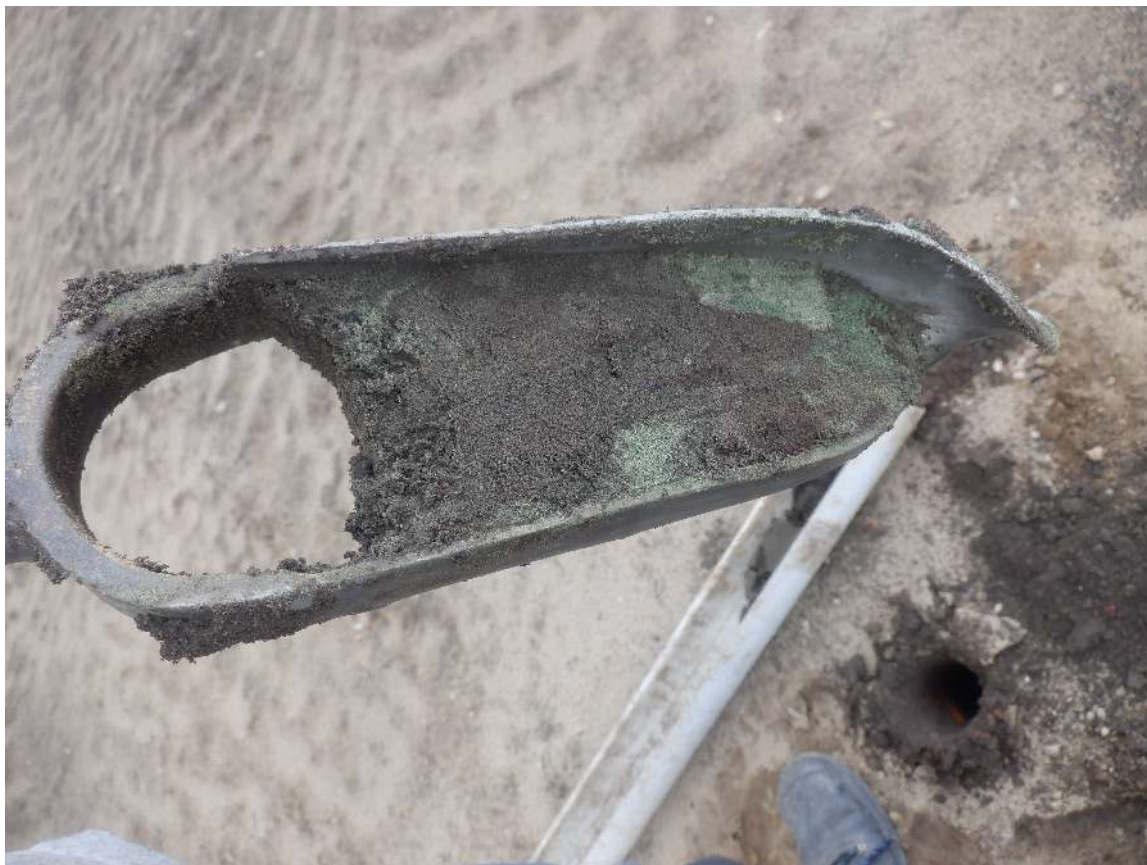
Afbeelding 4.2: Geroerde laag in boring 3.
