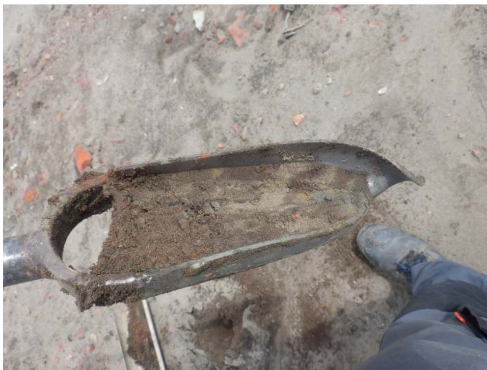
Afbeelding 4.1: Geroerde laag in boring 1.
