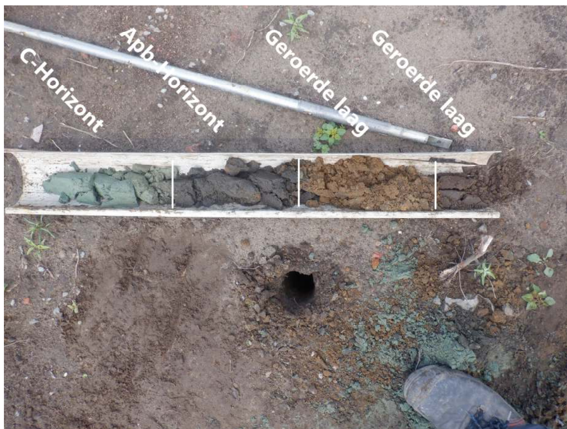
Afbeelding 4.3: Boring 4 met aanduiding van de verschillende horizonen.
