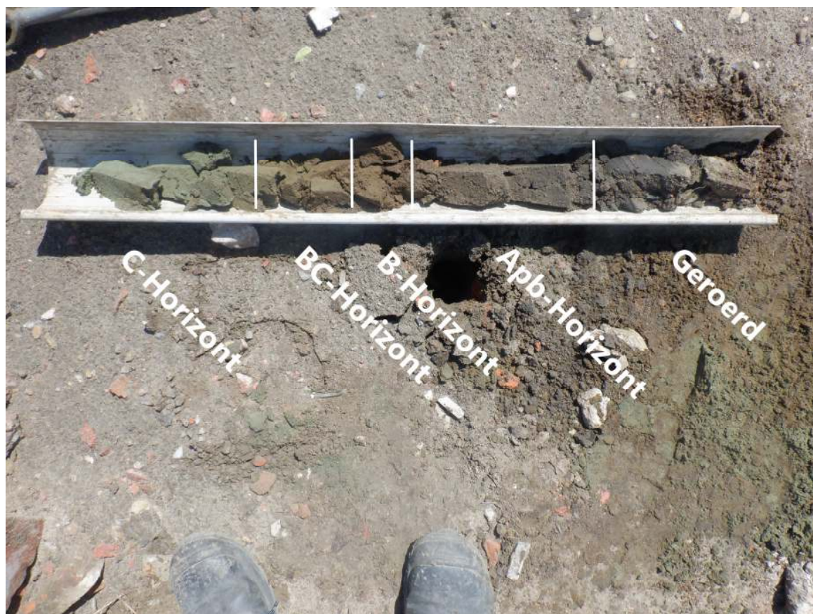
Afbeelding 4.4: Boring 5 met aanduiding van de verschillende horizonten.
