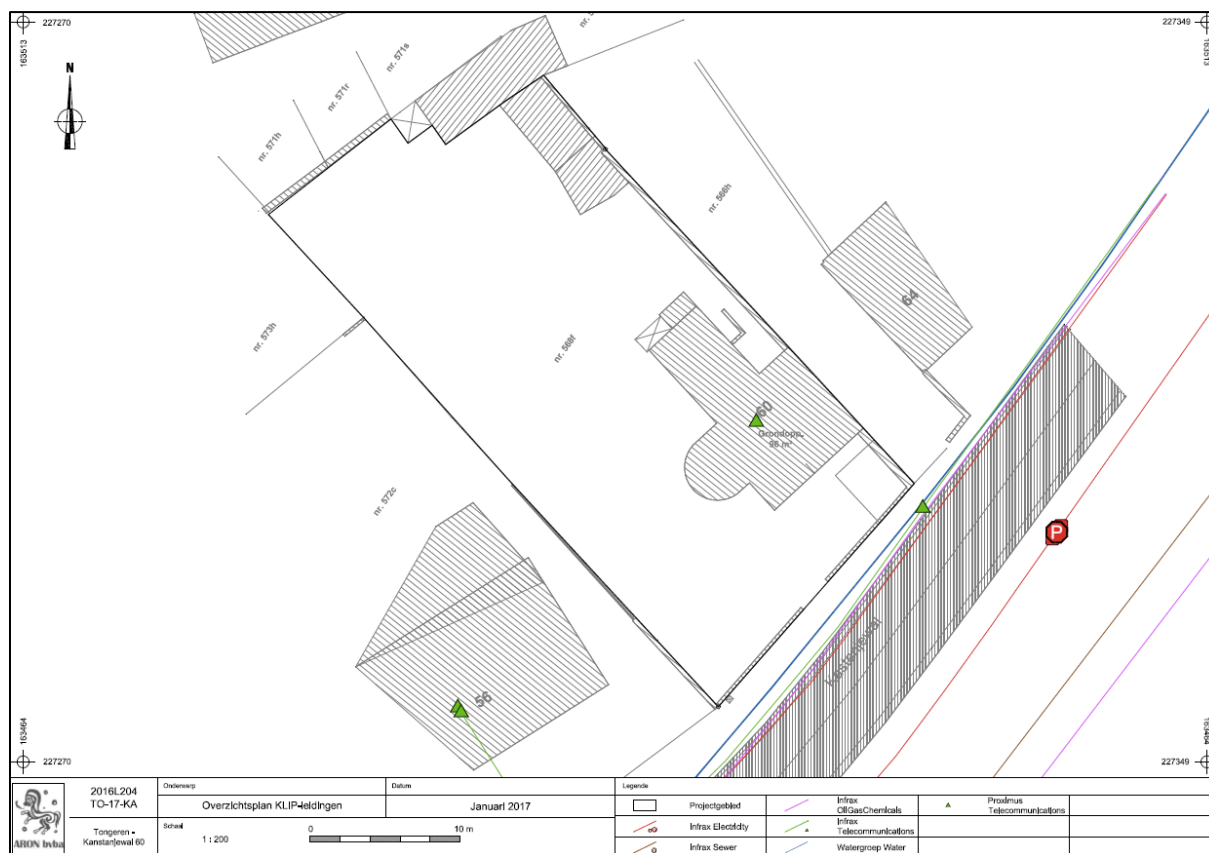
Afb. 41: Overzicht aanwezige nutsleidingen op het onderzoeksterrein (KLIP)
