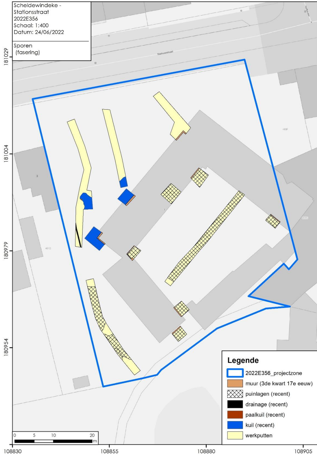
Figuur 42. Allesporenplan volgens type en met datering
