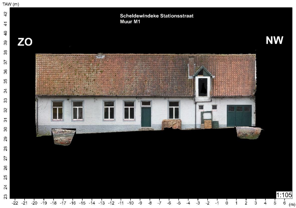
Figuur 26. Voorgevel muur M1 met locatie geregistreerde funderingen
