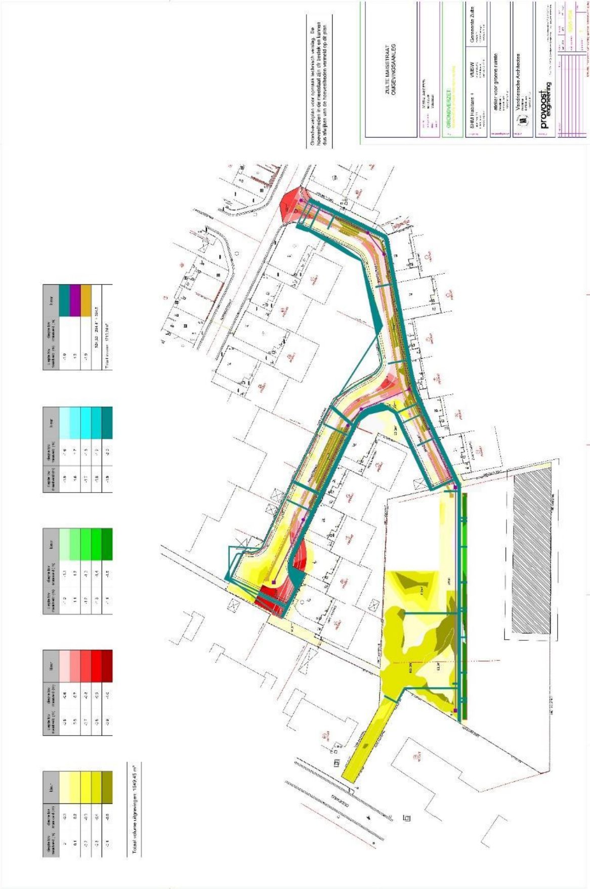
Figuur 7. Overzicht van de uitgravingen ter hoogte van de openbare werken (bron: opdrachtgever).
