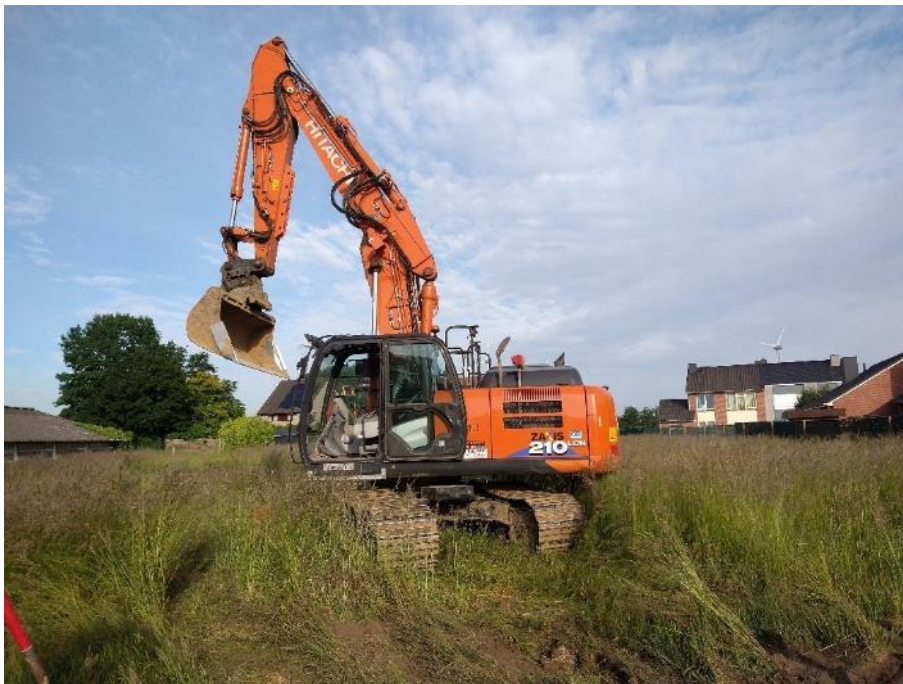
Figuur 35: kraan op rupsbanden met een gladde graafbak
