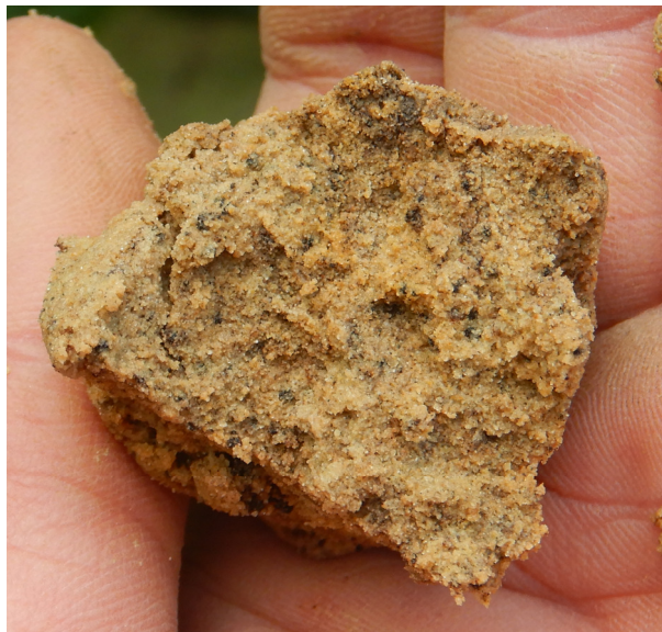
Figuur 27. Controleboring 3. Onder: detail van het onverweerd Pleistoceen sediment.
