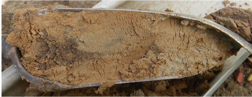
Figuur 26. Controleboring 2. Onder: overgang naar de C-horizont.
