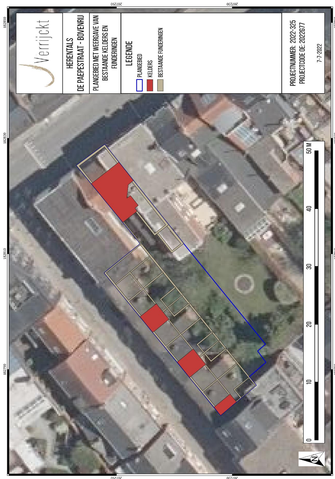
Figuur 8: Plangebied op orthofoto met weergave van de bestaande funderingen en kelders 15
