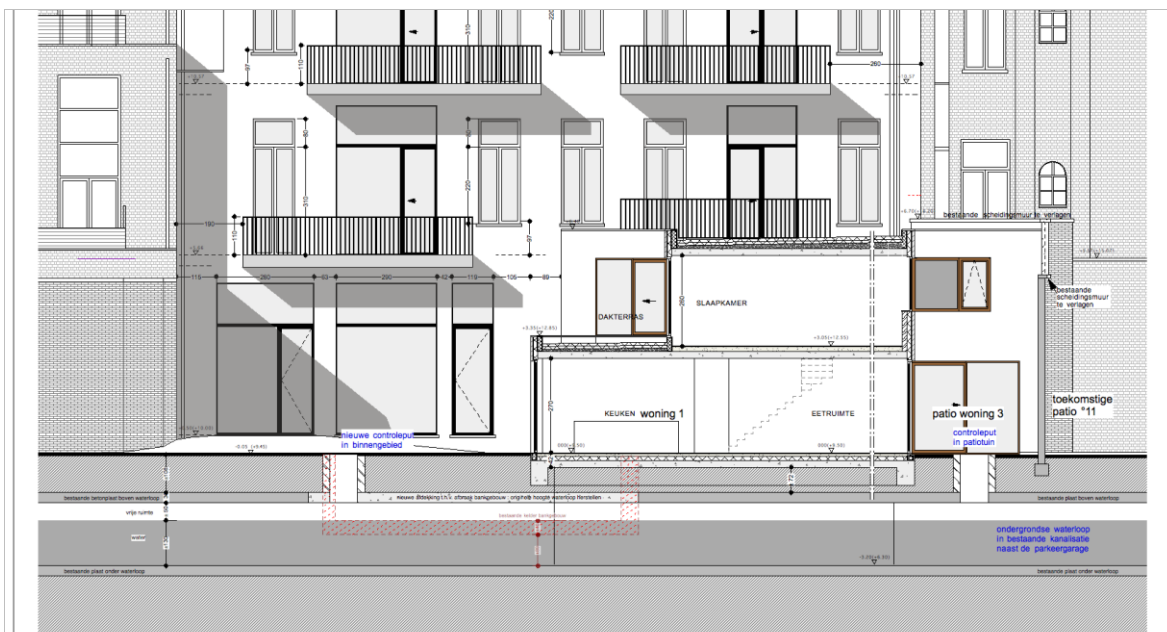
Figuur 14: Snede AA', Plan niveau -1, toekomstige toestand, pand Graaf Van Vlaanderenplein (Van Looveren, 2016)
