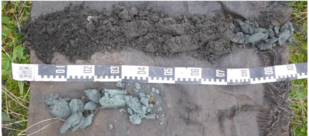
Figuur 33: Overzichtsfoto van boring BP2, uitgelegd van links naar rechts en van boven naar onder.
