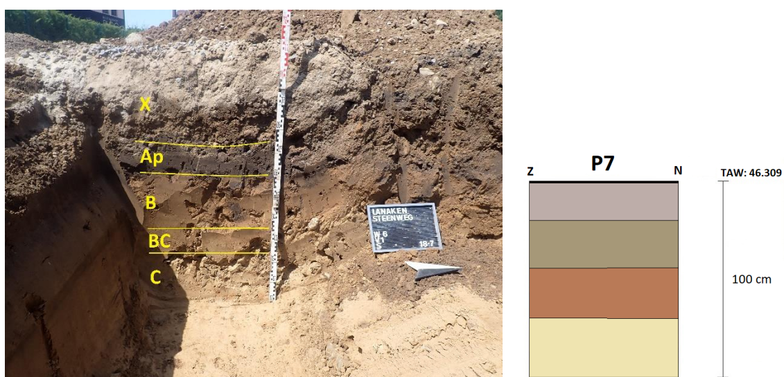
Figuur 50: Profiel P7 op foto en op tekening (© J. Verrijckt Bvba)
