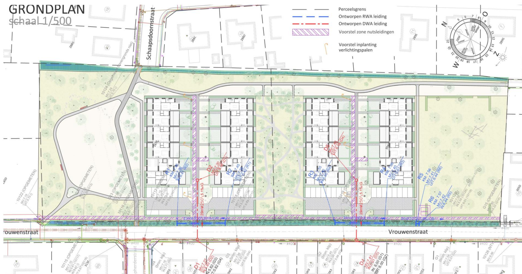
Figuur 5: Funderings- en rioleringsplan
