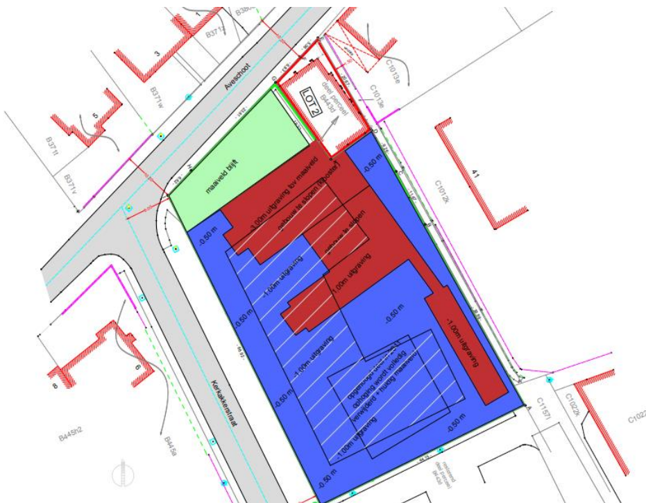
Figuur 8: Overzicht van de geplande uitgravingen.
