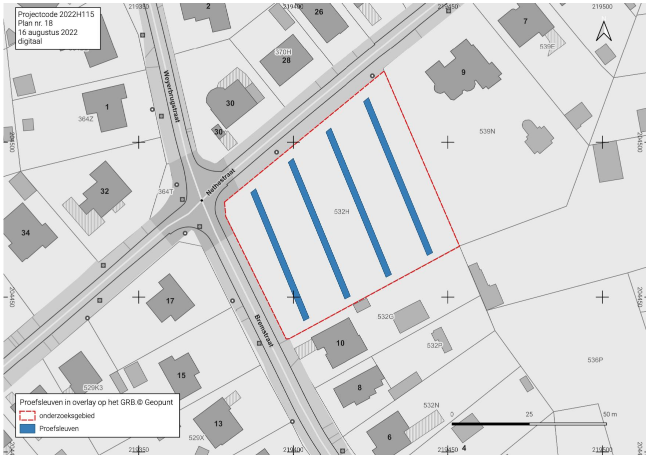
Fig. 22 Situering van de proefsleuven binnen het onderzoeksgebied en in overlay op het GRB. © Geopunt & Fodio
