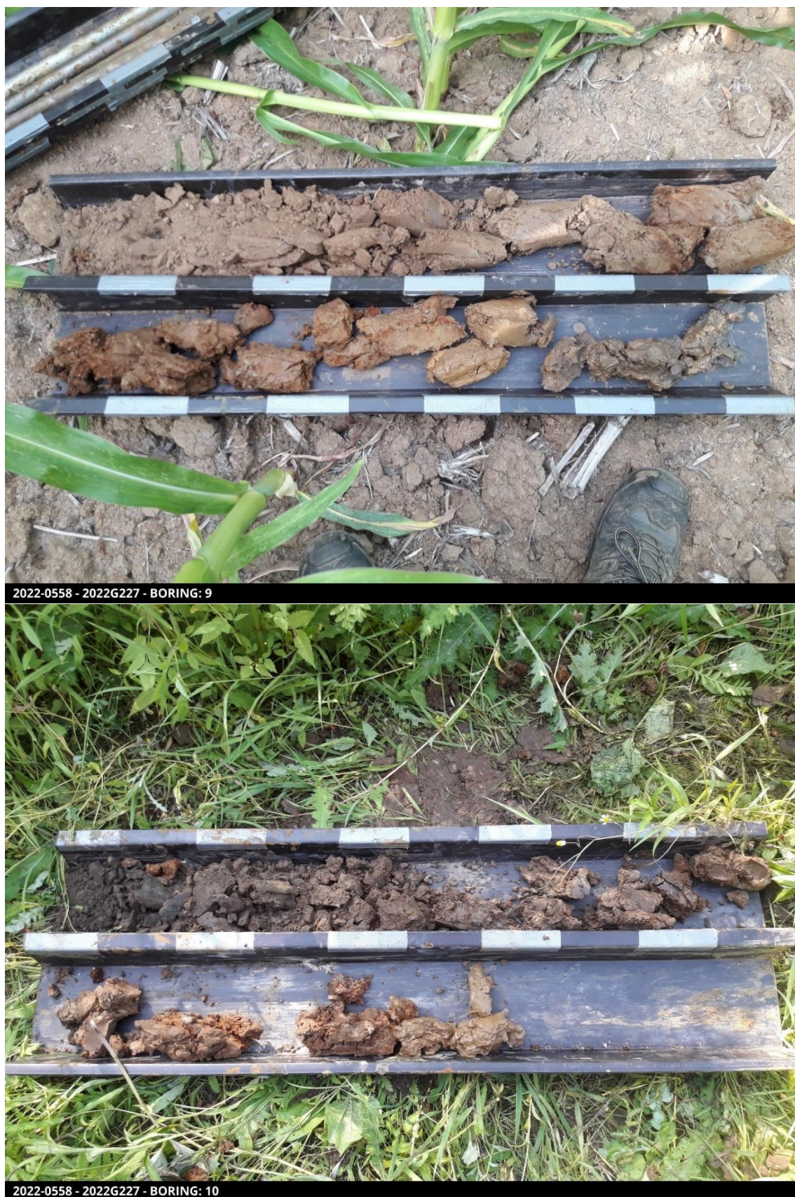
Figuur 12: Foto's van de uitgevoerde boringen (boring 9 en 10)
