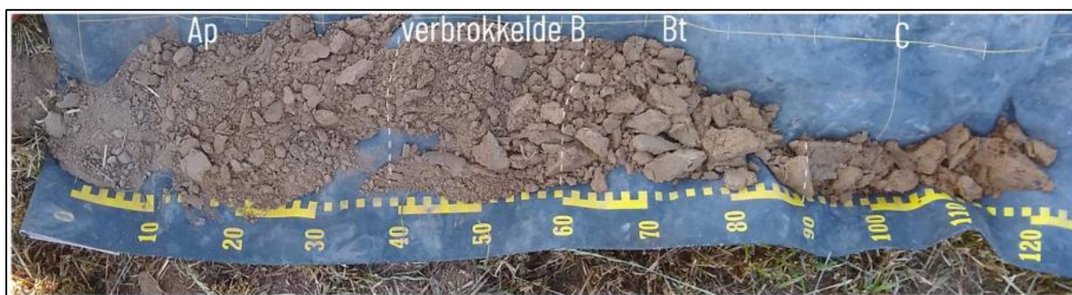
Figuur 7: Foto boring B8 – de eerste 50 cm is moeilijk leesbaar door de sterk uitgedroogde toestand van de bodem, het is dan ook niet uitgesloten dat de verbrokkelde B-horizont in feite een colluviale afzetting betreft. 16
