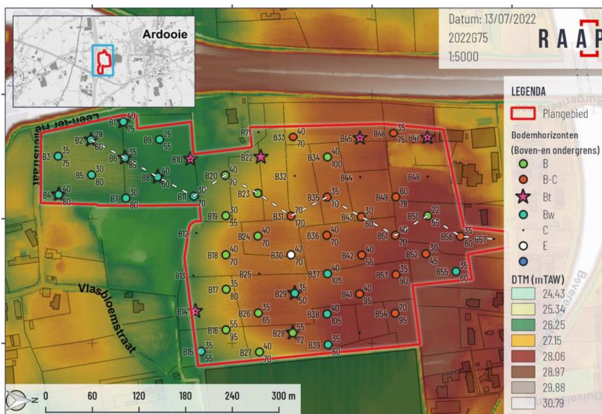
Figuur 8: Syntheseplan met overzicht van de vastgestelde bodemopbouw per boring, waarbij de boven- en ondergrens van de verbrokkelde B-horizont werd vermeld. (witte stippellijn = ZN doorsnede) 17
