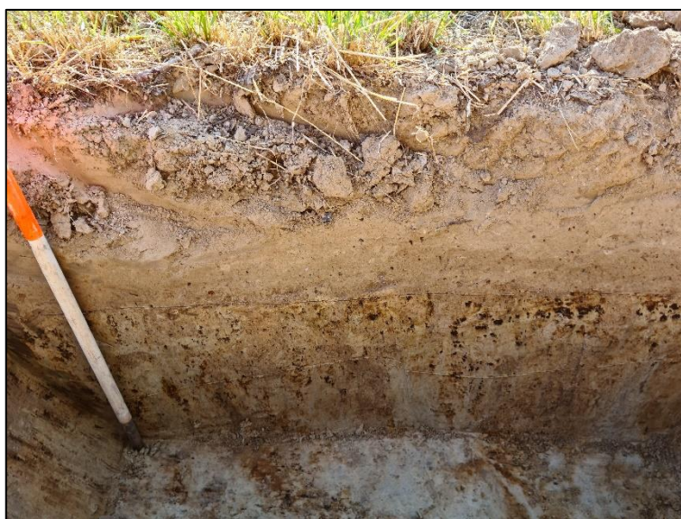
Figuur 10: Profielpit 5 met een Ap-Bs-C bodemopbouw
