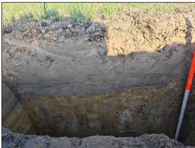
Figuur 9: Profielpit 1 met een Ap1-Ap2-B-Bs-C bodemopbouw
