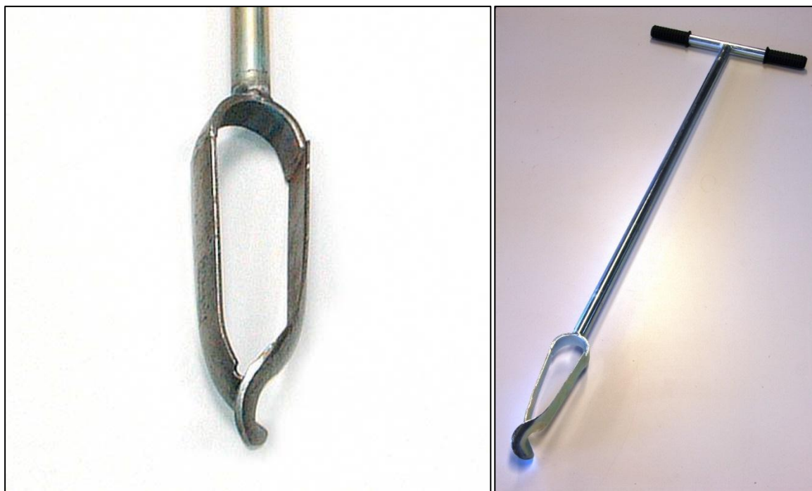
Figuur 36: Combiboer met een diameter van 7 cm (Bron: http://www.eijkelkamp.com en http://www.wrm.nl )
