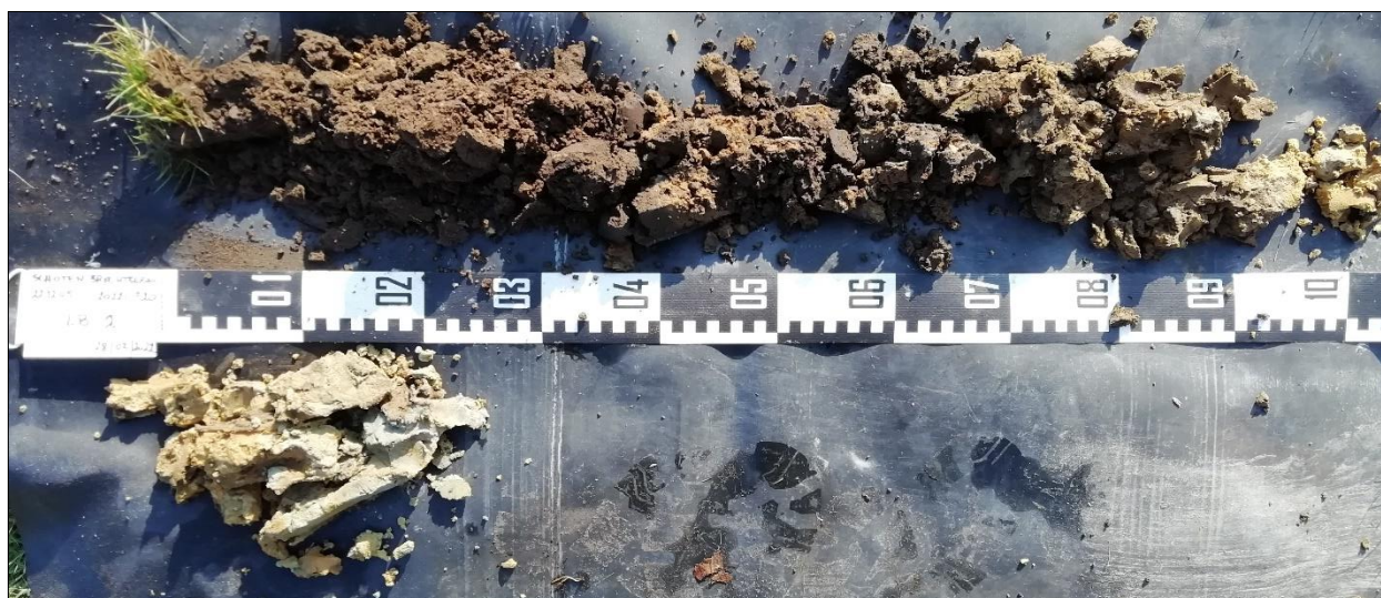
Figuur 12: Boring 2 van 0 cm links boven tot 120 cm links beneden.
