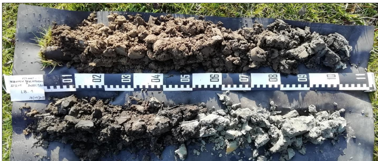
Figuur 11: Boring 1 van 0 cm links boven tot 200 cm rechts beneden.
