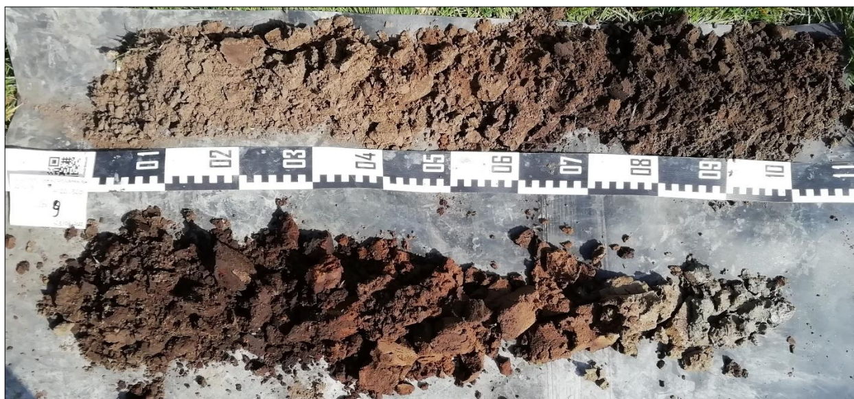
Figuur 19: Boring 9 van 0 cm links boven tot 200 cm rechts beneden.
