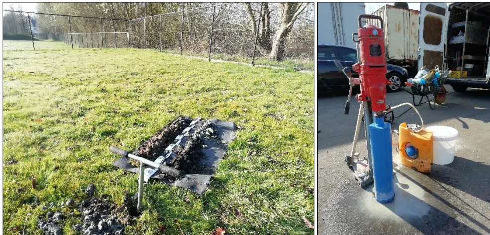
Figuur 6: Voorbeeld handmatige en mechanische uitvoering van een boring.
