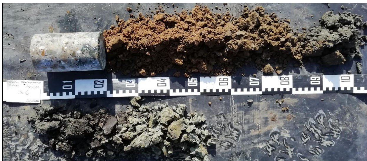
Figuur 16: Boring 6 van 0 cm links boven tot 200 cm centraal beneden.
