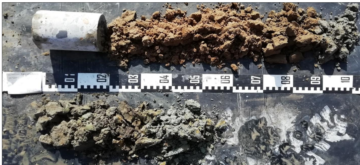
Figuur 15: Boring 5 van 0 cm links boven tot 200 cm centraal beneden.
