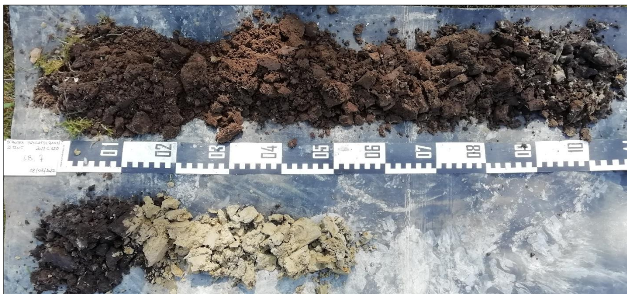
Figuur 17: Boring 7 van 0 cm links boven tot 150 cm centraal beneden.
