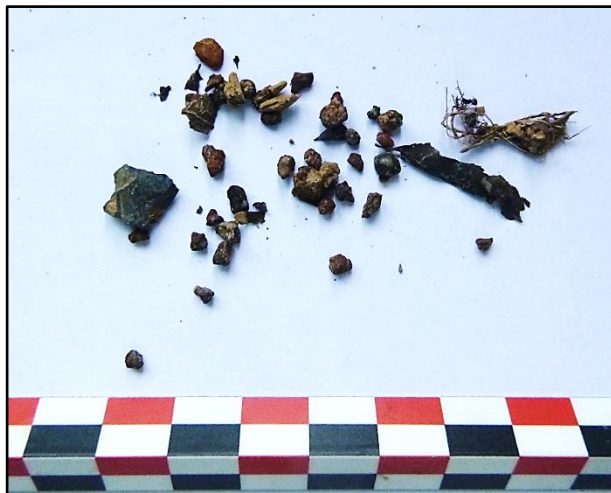
Figuur 18: Representatief zeefresidu met ijzerconcreties in de C-horizont, boring 16.
