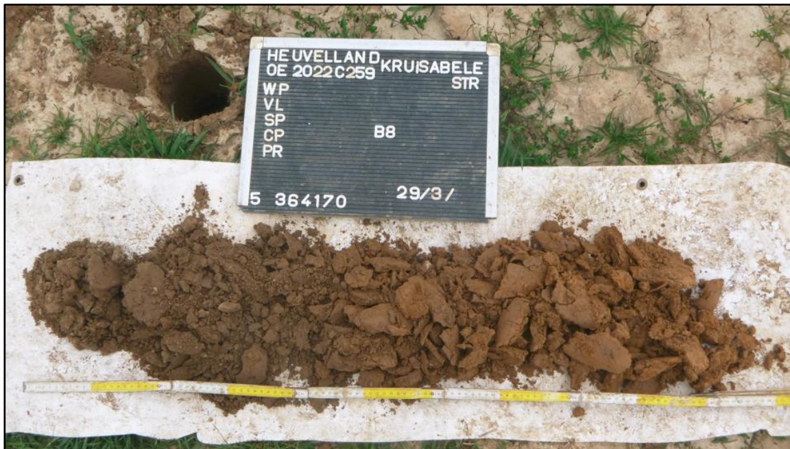
Figuur 13: Referentieboring 8 met Ap-B-C bodemprofiel (ABO nv 2022)
