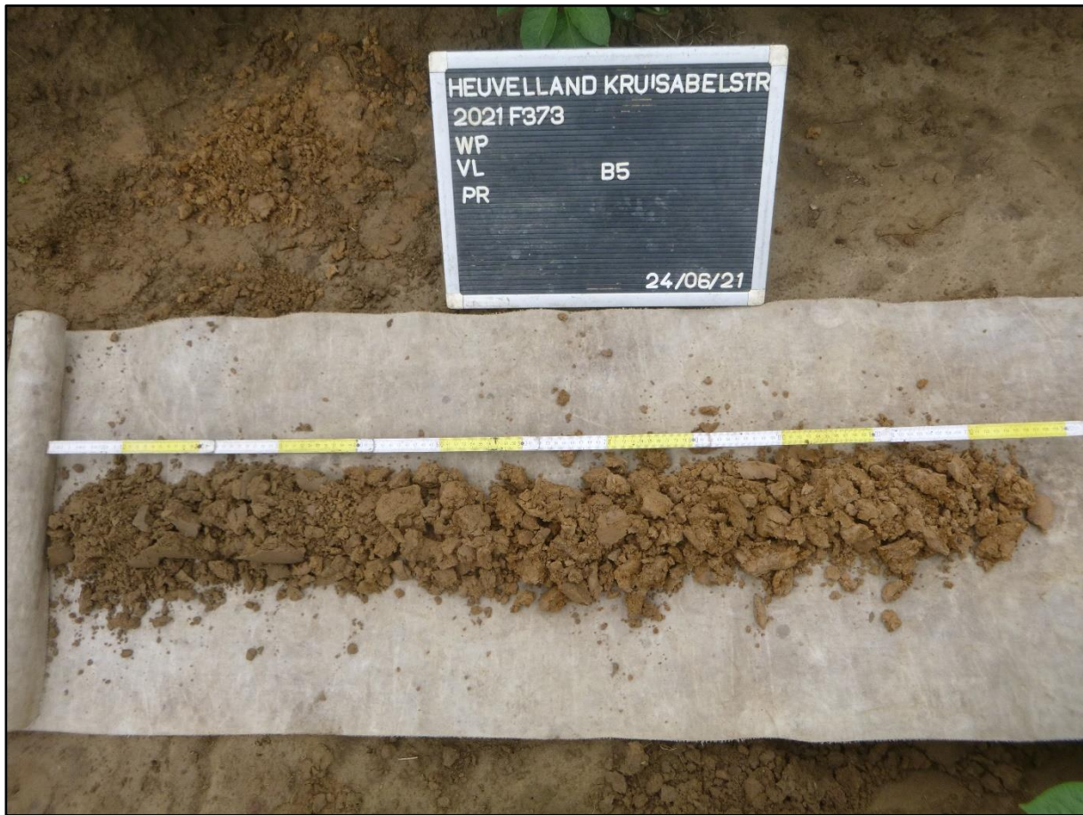
Figuur 4: A-B-C bodemprofiel bij boorpunt 5 (ABO nv 2021).
