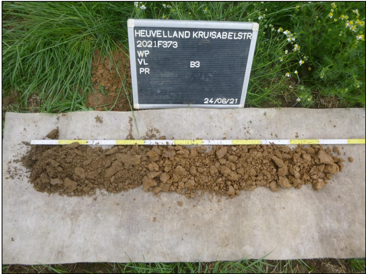
Figuur 5: A-C bodemprofiel bij boorpunt 3 (ABO nv 2021).
