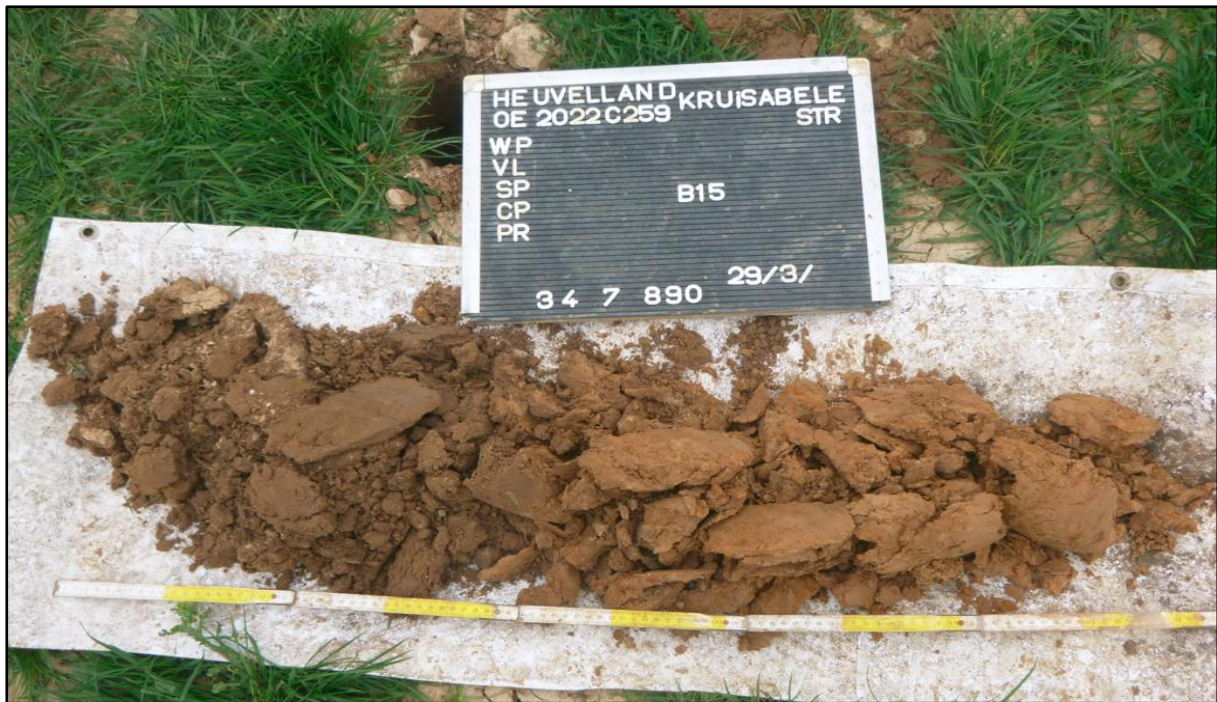
Figuur 15: Referentiebooring voor Ap-C bodemprofielen (Ada-bodem, zuidoostelijk deel) (ABO nv 2022)
