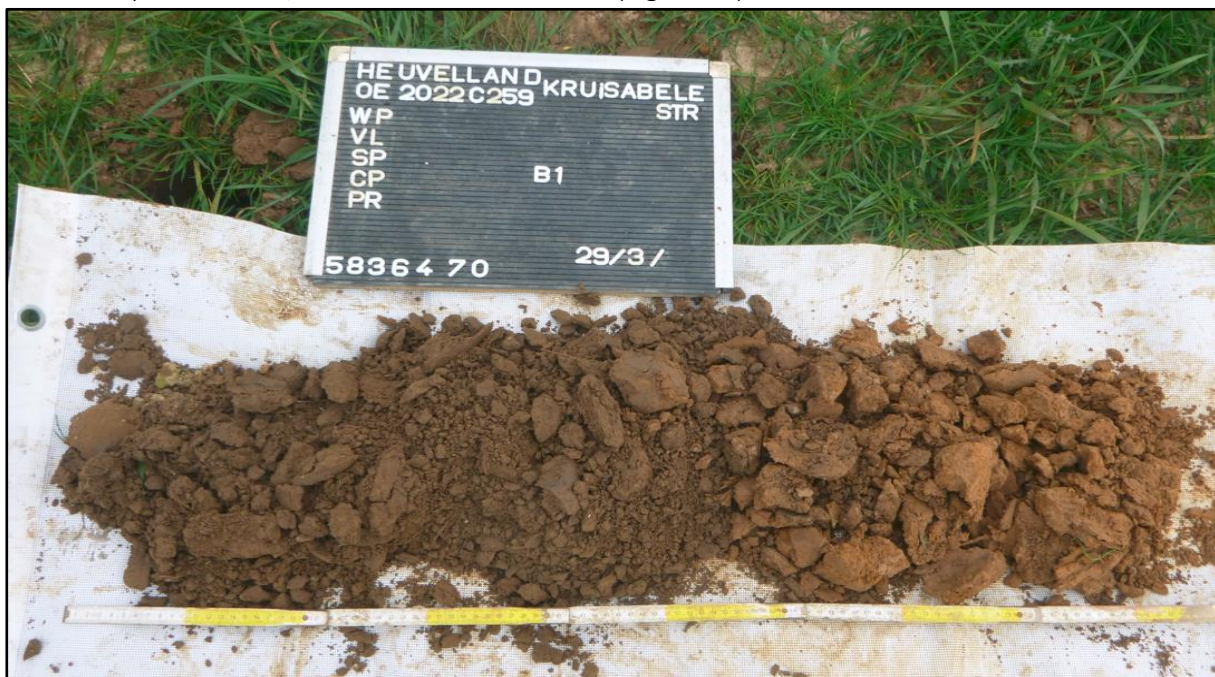
Figuur 14: Boring 1 (Ap-C bodemprofiel) met relatief diepe bouwvoor (ABO nv 2022)
