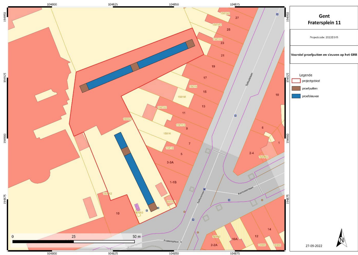
Figuur 2: Voorstel proefputten en sleuven.
