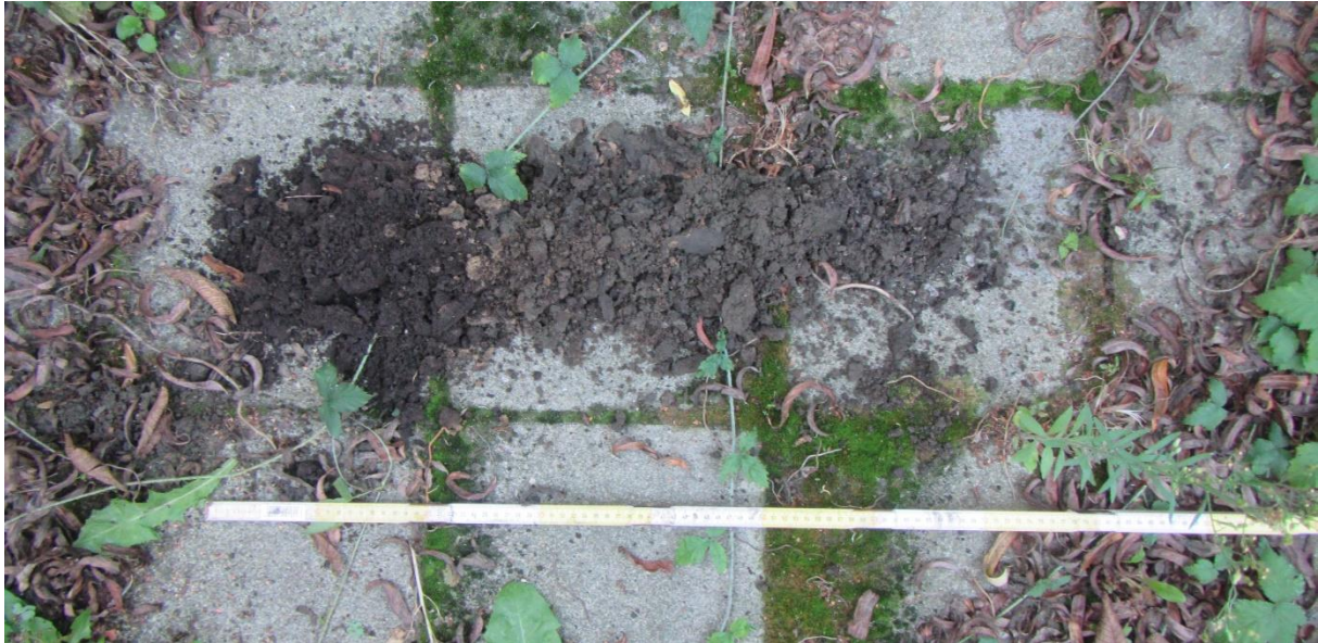
Figuur 35: Boring 4 (B4), een voorbeeld van een boring met een diepe antropogene verstoring. Onderaan ligt de donkerbruingrijze tot lichtgrijze zandige laag met een grote hoeveelheid mortel en baksteenpuin en bovenaan de donkerbruine tuinbodem
