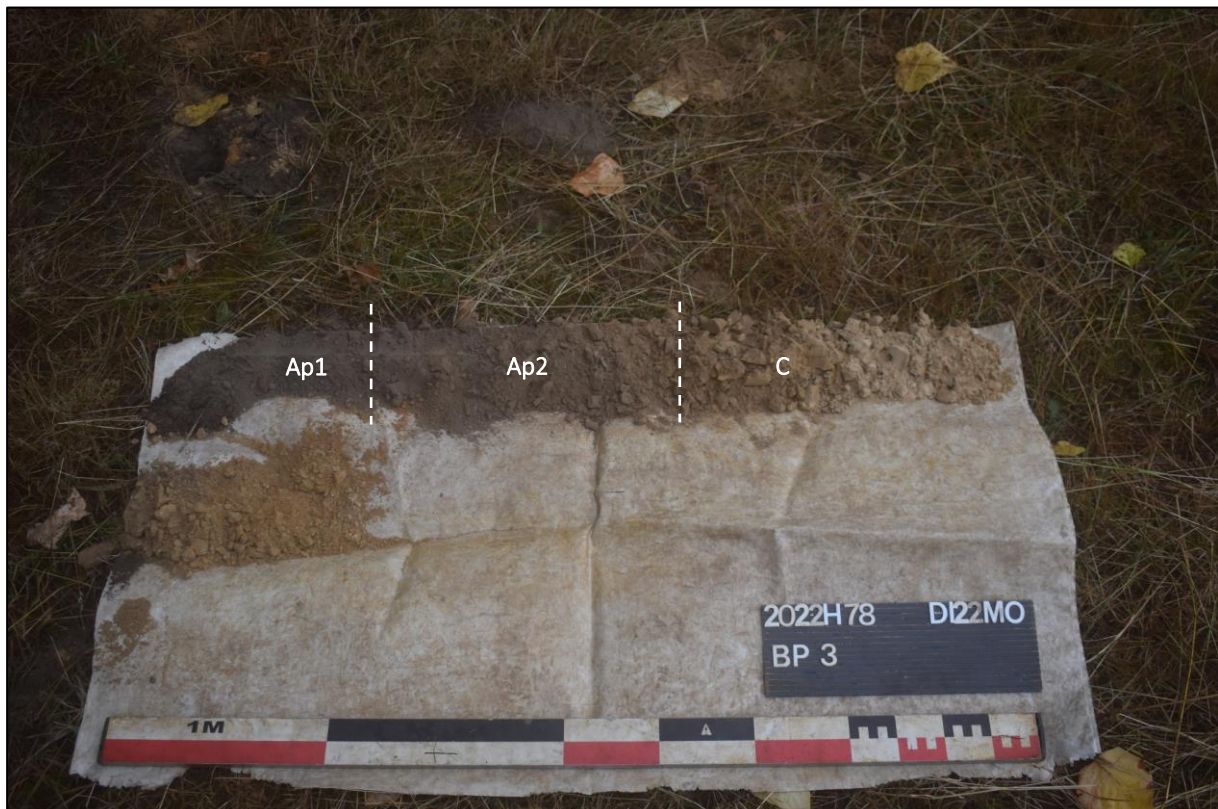
Afb.19: Profielfoto BP3 met A-C bodemprofiel met gelaagde bouwvoor
