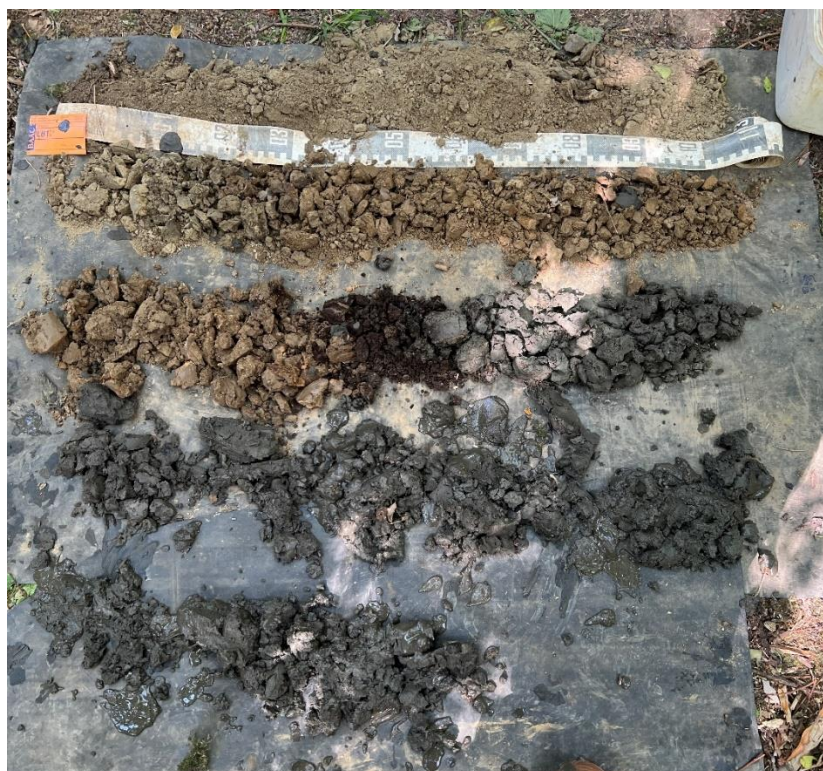
Figuur 6 : Boring 1, van 0 (linksboven) naar 470 cm (midden onder) beneden het maaiveld.
