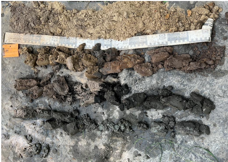
Figuur 13 : Boring 8, van 0 (linksboven) naar 420 cm (linksonder) beneden het maaiveld.
