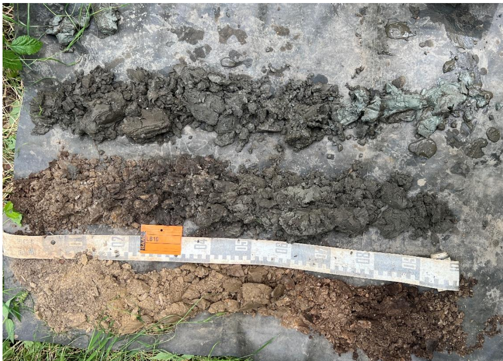
Figuur 15 : Boring 10, van 0 (linksonder) naar 320 cm (rechtsboven) beneden het maaiveld.
