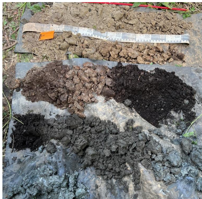
Figuur 8 : Boring 3, van 0 (linksboven) naar 430 cm (midden onder) beneden het maaiveld.
