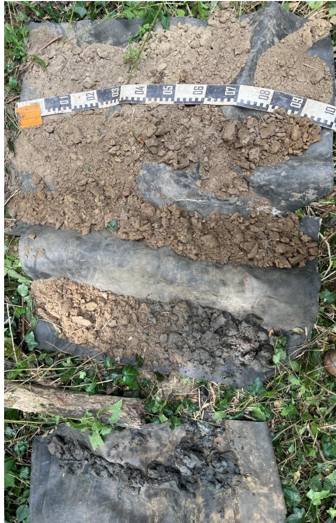
Figuur 9 : Boring 4, van 0 (linksboven) naar 470 cm (rechtsonder) beneden het maaiveld.
