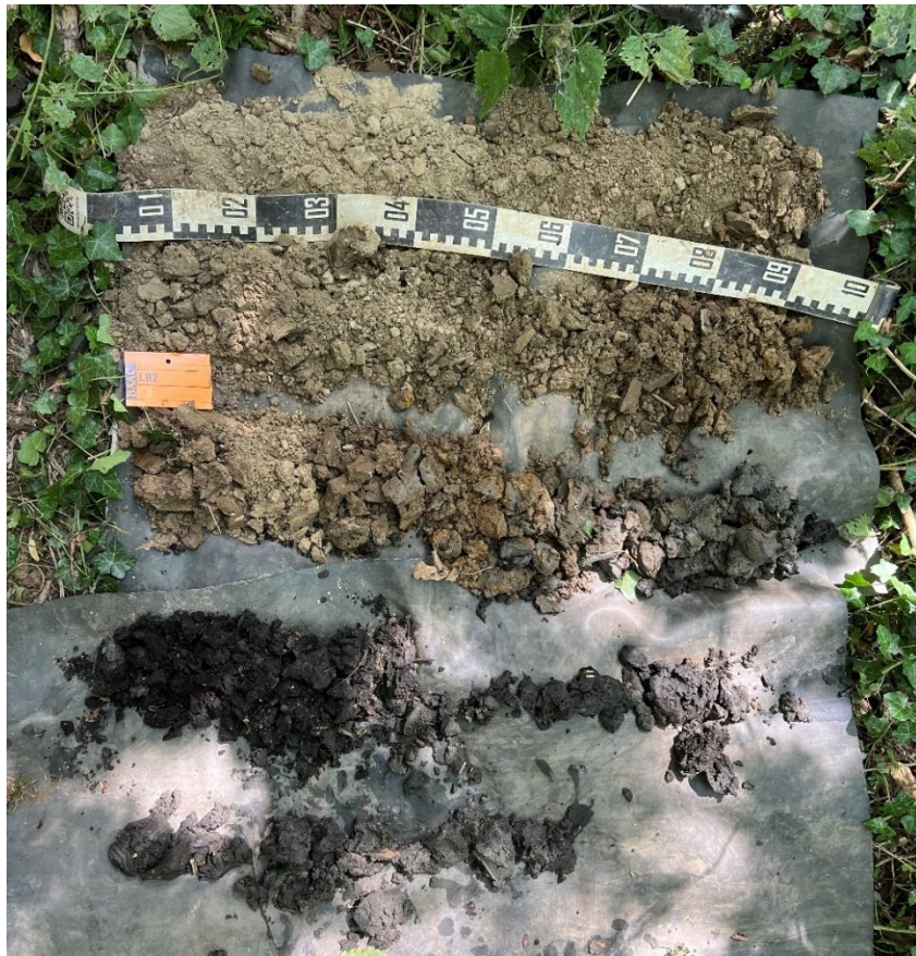
Figuur 7 : Boring 2, van 0 (linksboven) naar 470 cm (midden onder) beneden het maaiveld.
