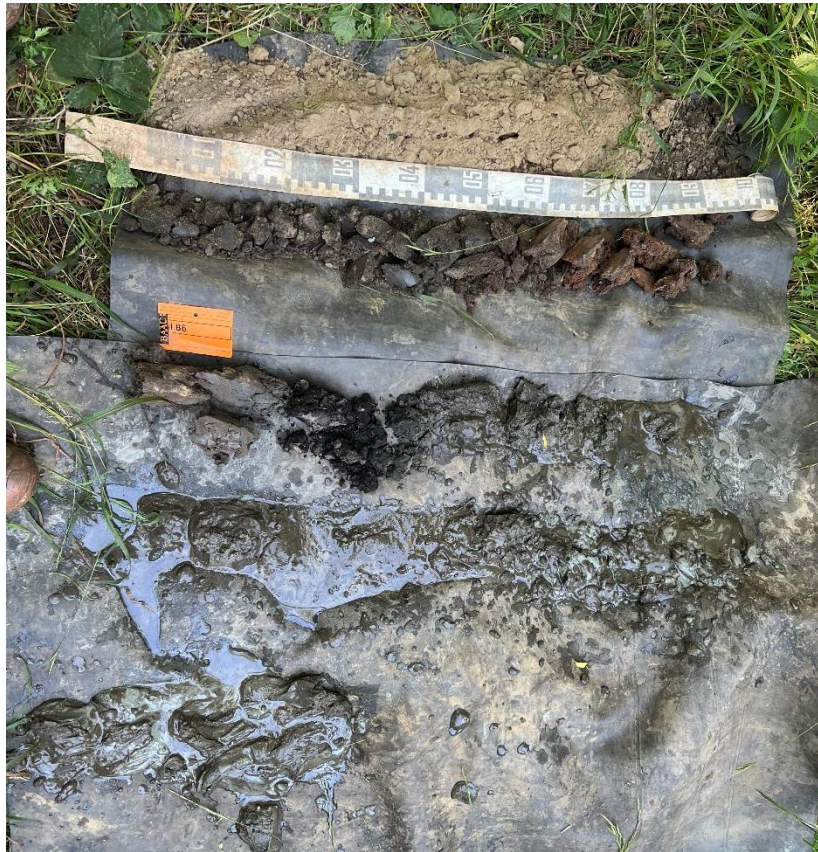
Figuur 11 : Boring 6, van 0 (linksboven) naar 420 cm (linksonder) beneden het maaiveld.
