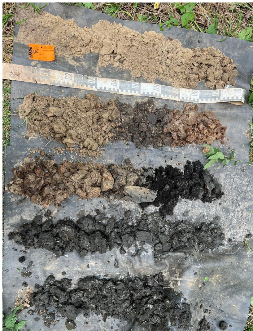
Figuur 12 : Boring 7, van 0 (linksboven) naar 470 cm (rechtsonder) beneden het maaiveld.
