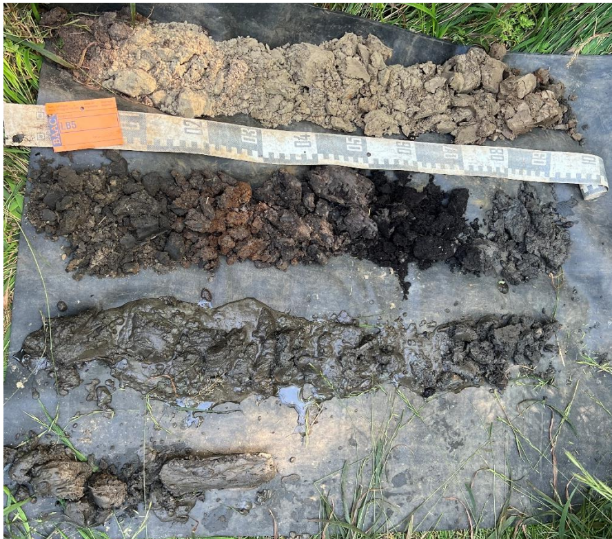
Figuur 10 : Boring 5, van 0 (linksboven) naar 340 cm (linksonder) beneden het maaiveld.
