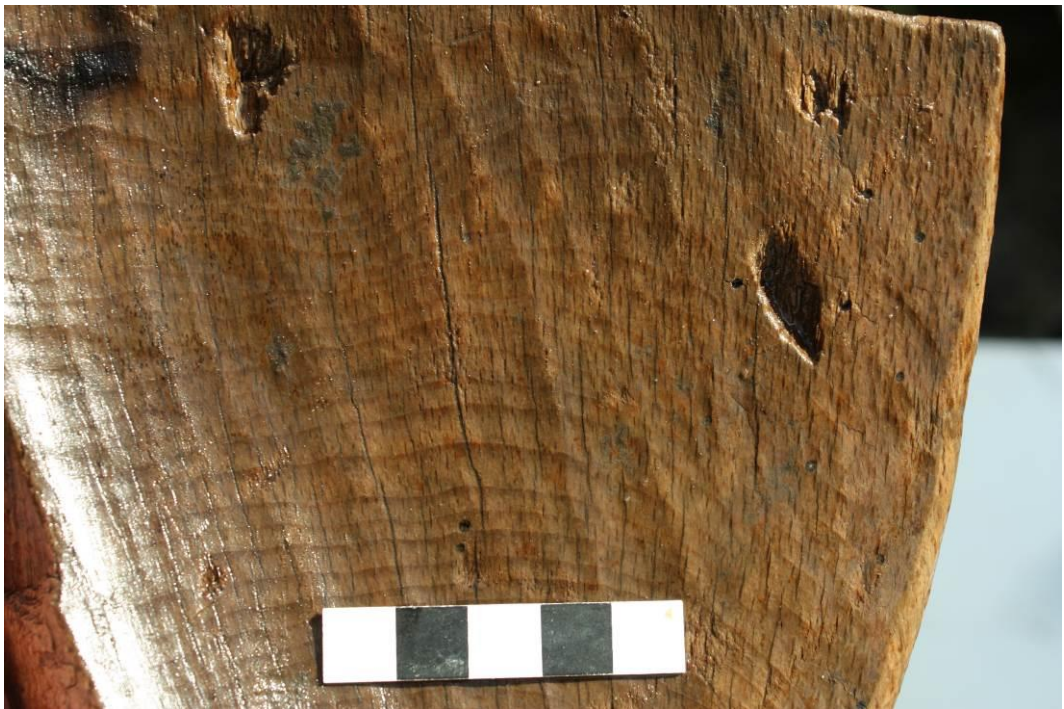
Figuur 12 Gistel-Neerhofstraat 15, de binnenzijde van het blad met bewerkingsporen van een guts (© BIAX).
