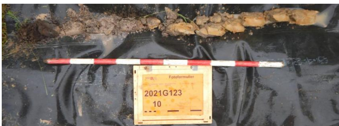
Figuur 11: Boring 10, uitgelegd per meter van links naar rechts
