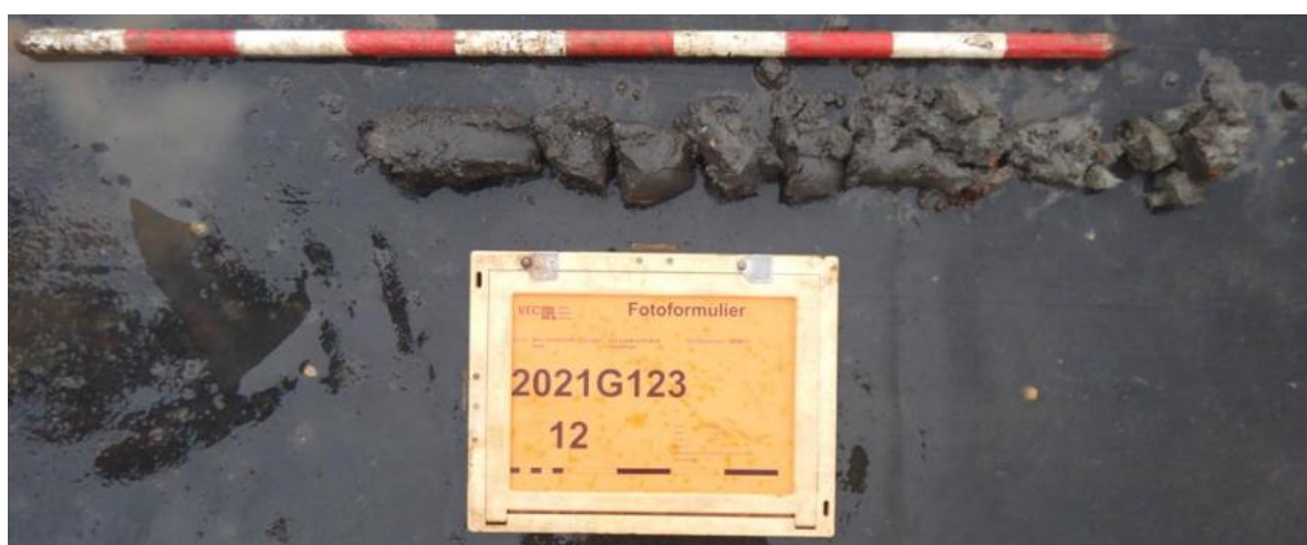
Figuur 12: Boring 12, uitgelegd per meter van links naar rechts
