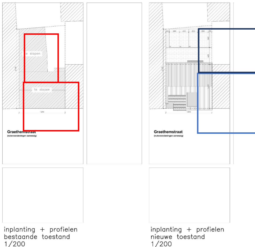
Afbeelding 3: De bestaande toestand (in rood, te slopen) en de nieuwe toestand (in blauw). zoals aangereikt door de opdrachtgever LT Invest
