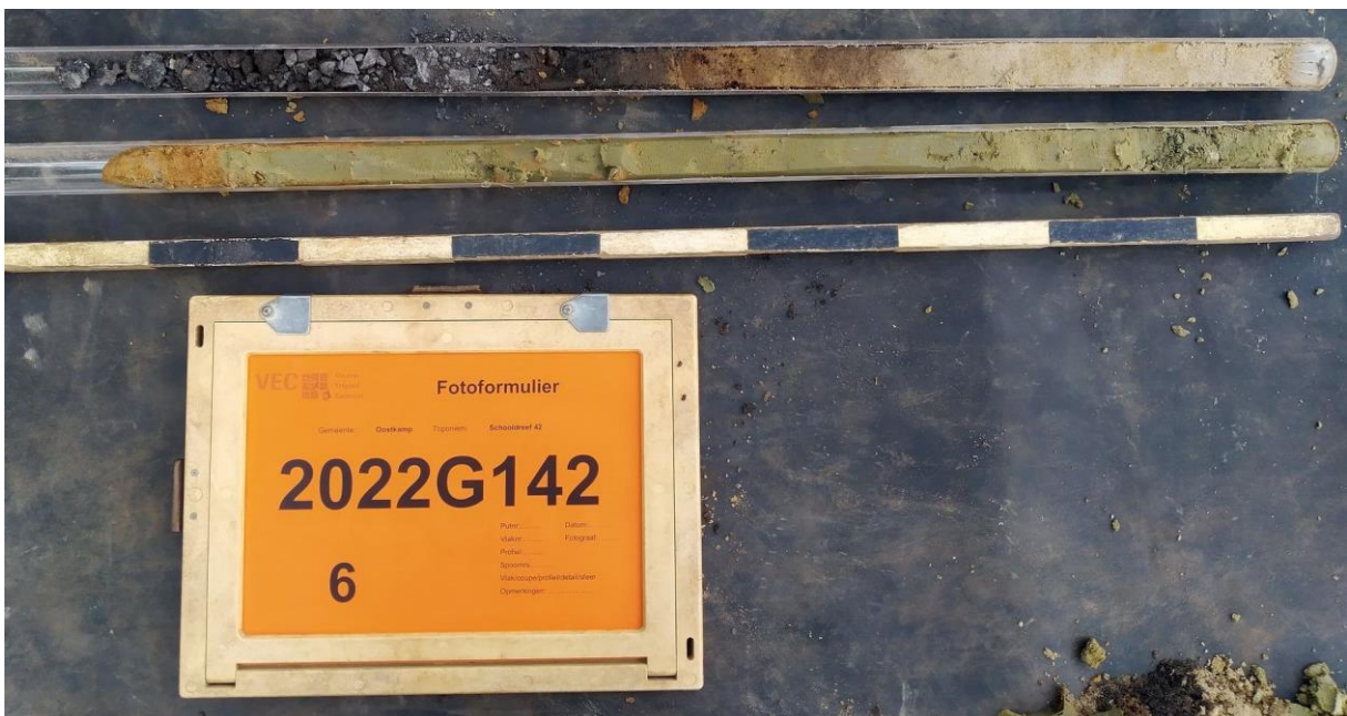
Figuur 30: Boring 6, uitgelegd van links naar rechts; 1 liner = 120 cm.
