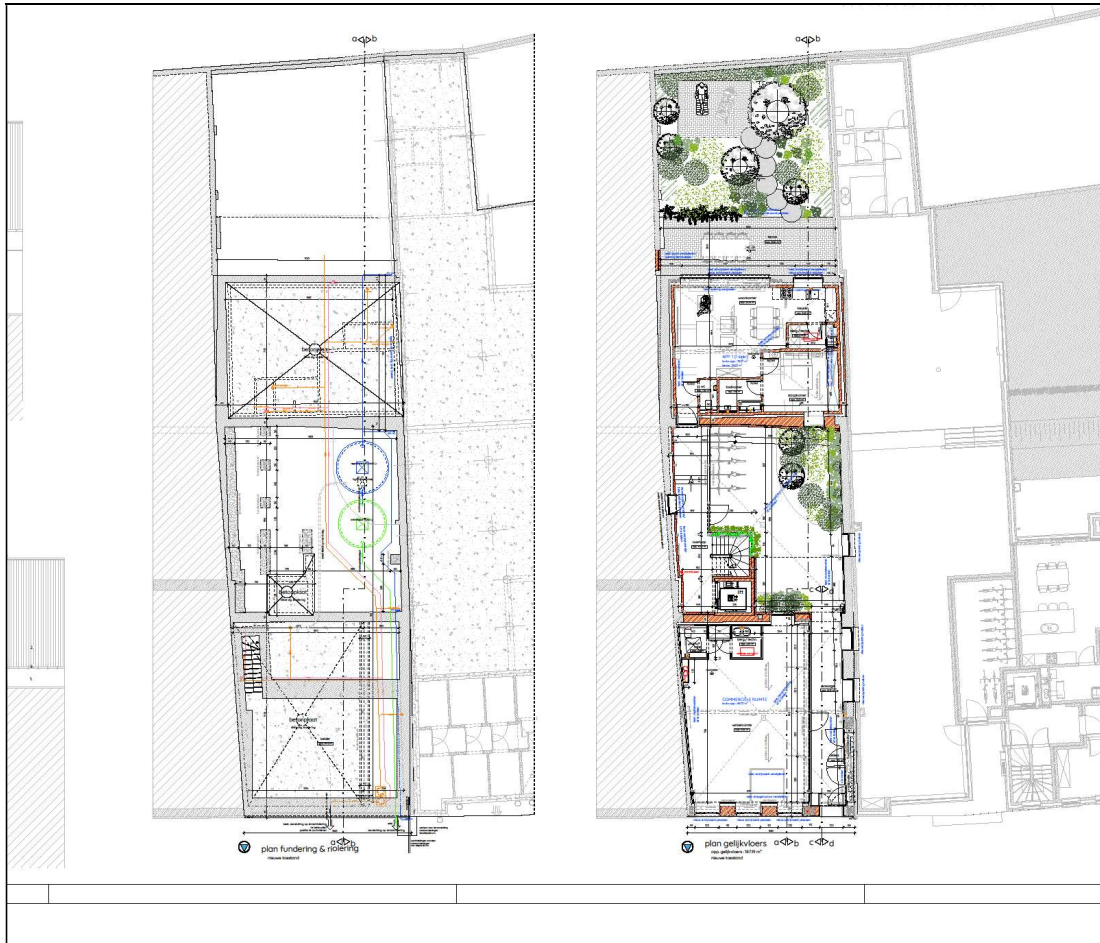
Afb 4: detail van ontwerp toestand: Links funderings- rioleringsplan; rechts gelijkvloer (Bron: initiatiefnemer, aanmaakschalen 1/50, 1/100, 1/250, 11/08/2022, 2022K61)
