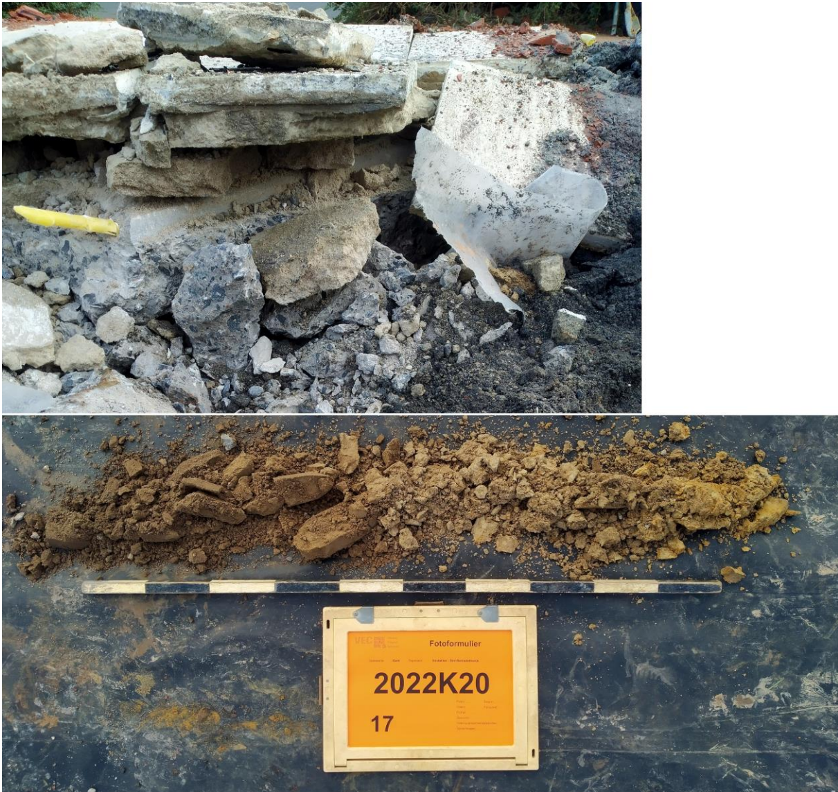
Figuur 6: Boven: opbouw van de vloer onder de huizen (vloertegels + vloerplaat/verharding in beton). Onder: rest van boring 17, vanaf 40 cm-mv (onder de vloerplaat).
