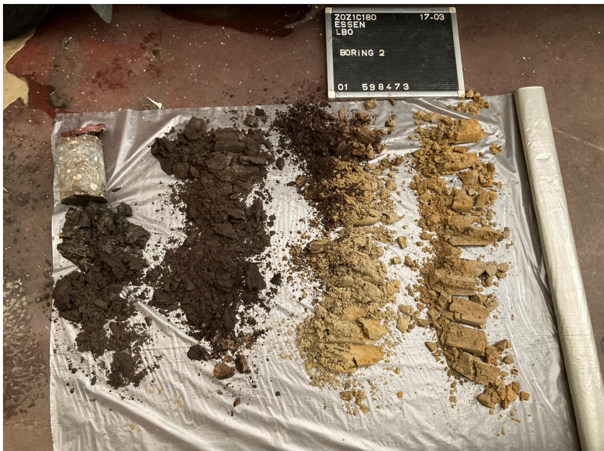
Figuur 22: Boorprofiel en foto van Boring 2. Elke rij is 0,50 meter boring. (Bron: ABO nv 2021).
