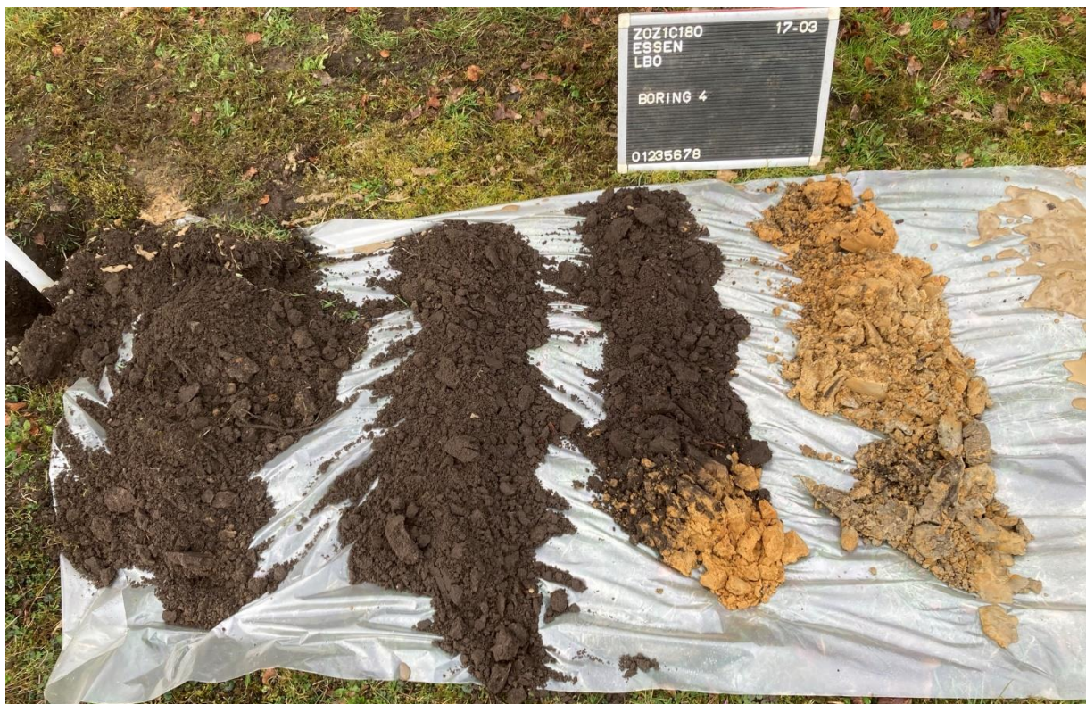
Figuur 23: Boorprofiel en foto van Boring 4. Elke rij is 0,50 meter boring. (Bron: ABO nv 2021).
