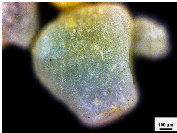
figuur 37: Rivierzandkorrel met een diameter van ca. 1 mm. Kenmerkend is het relatief ruwe oppervlak als gevolg van het afschilferen van fijne deeltjes tijdens saltatietransport.
