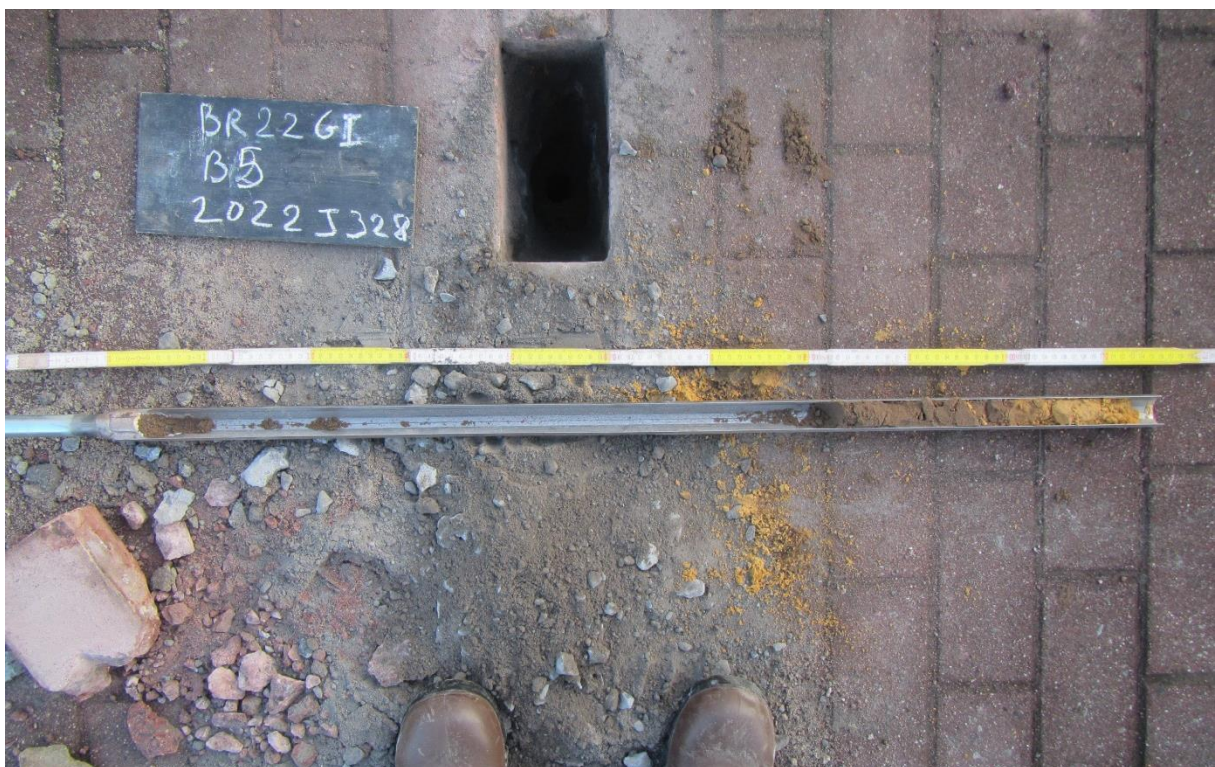
Figuur 16: Boring 5 (B5) een voorbeeld van een sterk verstoord boorprofiel
