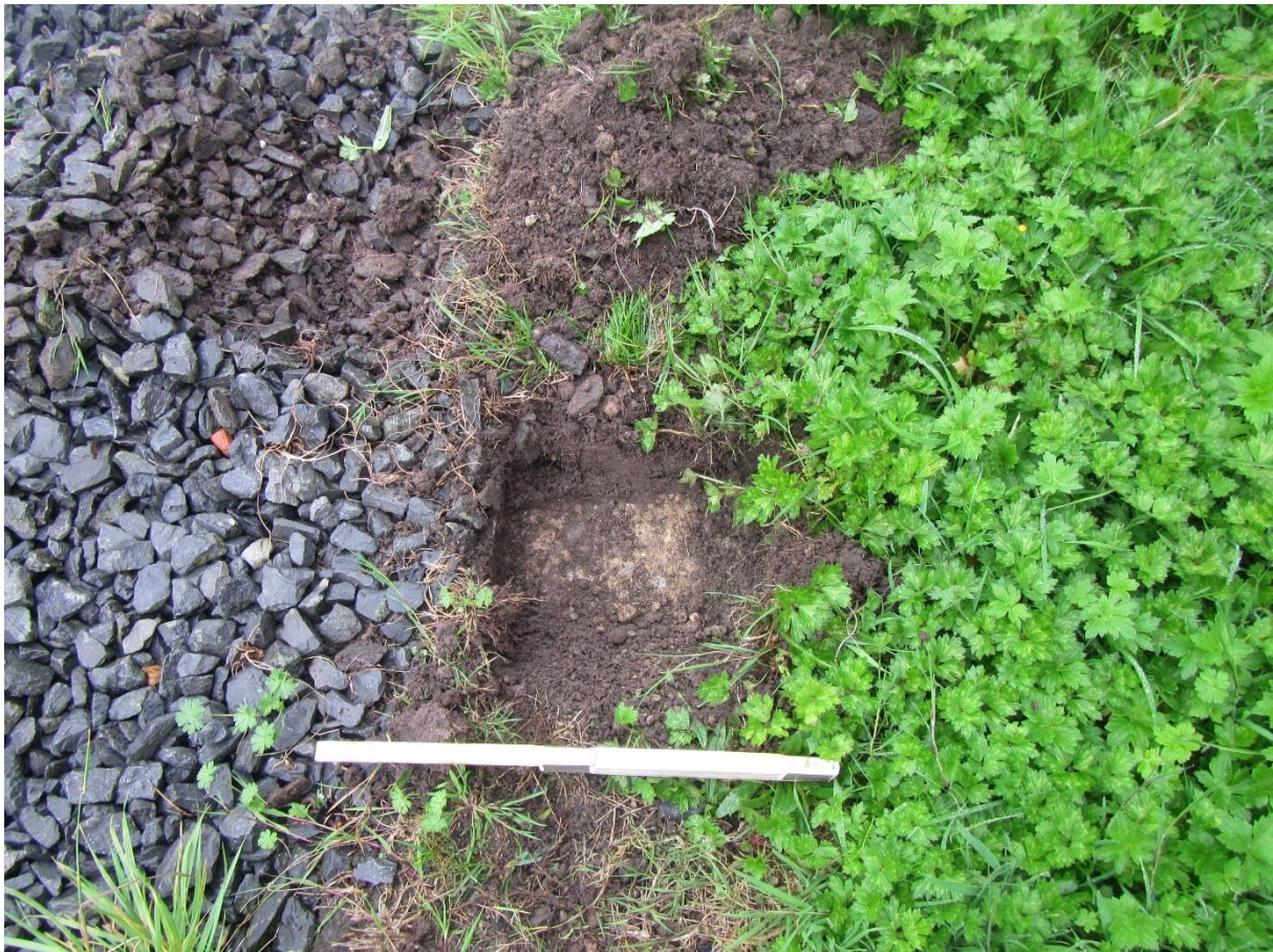
Figuur 20: Controleputje bij de parkeerstrook, dieper graven lukt niet door de verharding
