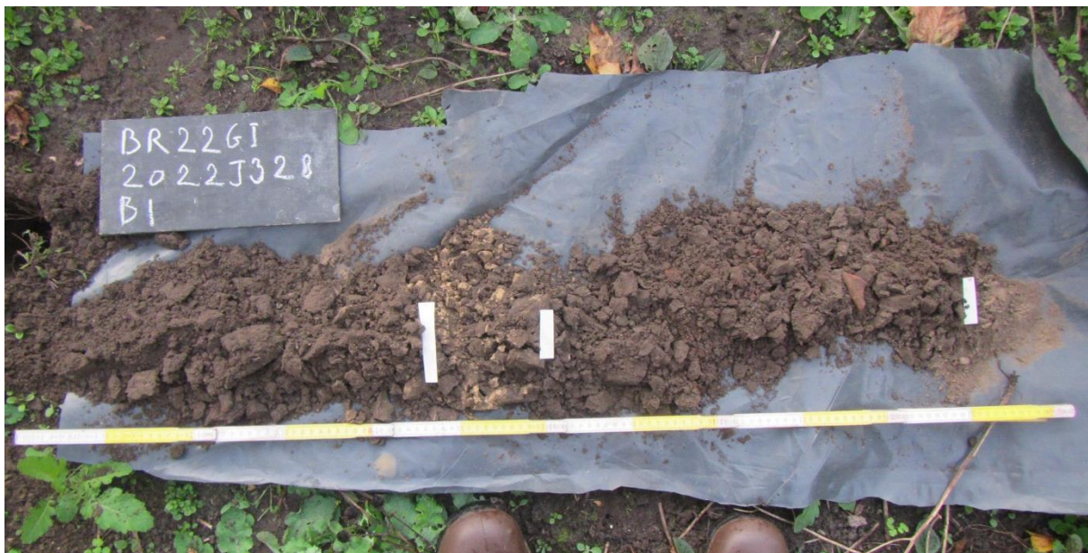
Figuur 14: Boring 1 (B1) een voorbeeld van een sterk verstoord boorprofiel
