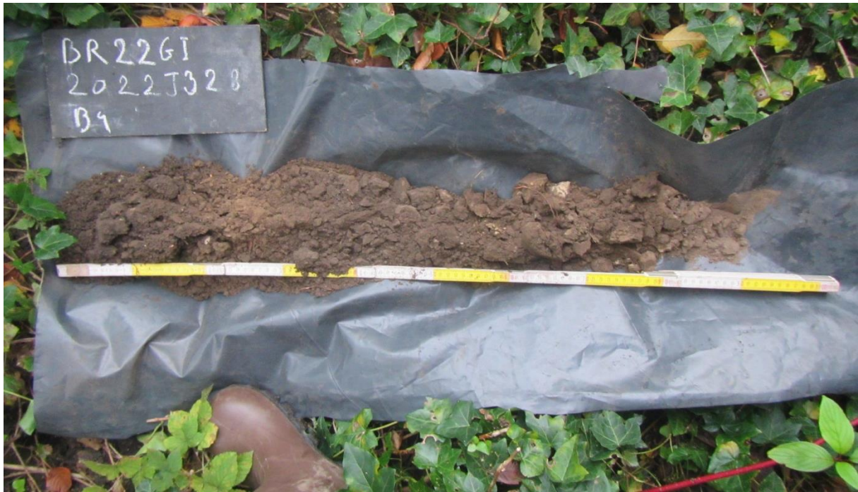
Figuur 15: Boring 4 (B4) een voorbeeld van een sterk verstoord boorprofiel
