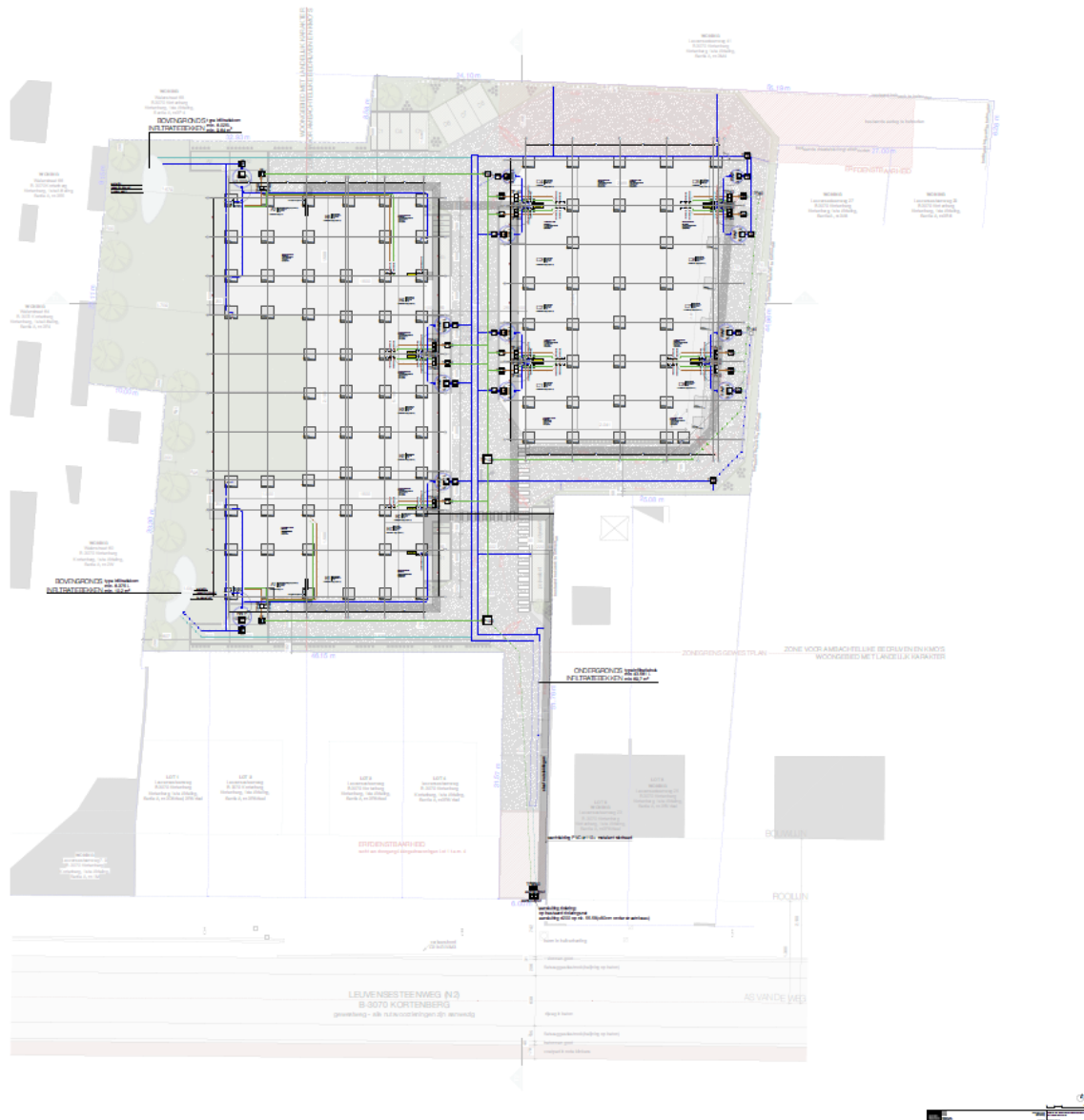
Figuur 10: Funderings- en rioleringsplan (initiatiefnemer, 2021)
