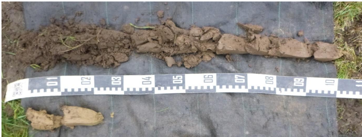
Figuur 15 Overzichtsfoto van boring BP1, uitgelegd van links naar rechts en van boven naar onder (overgenomen uit LBO-rapport 2022A431)
