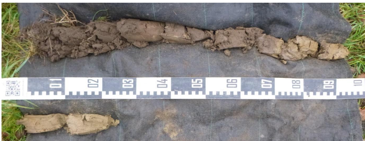
Figuur 16 Overzichtsfoto van boring BP2, uitgelegd van links naar rechts en van boven naar onder (overgenomen uit LBO-rapport 2022A431)
