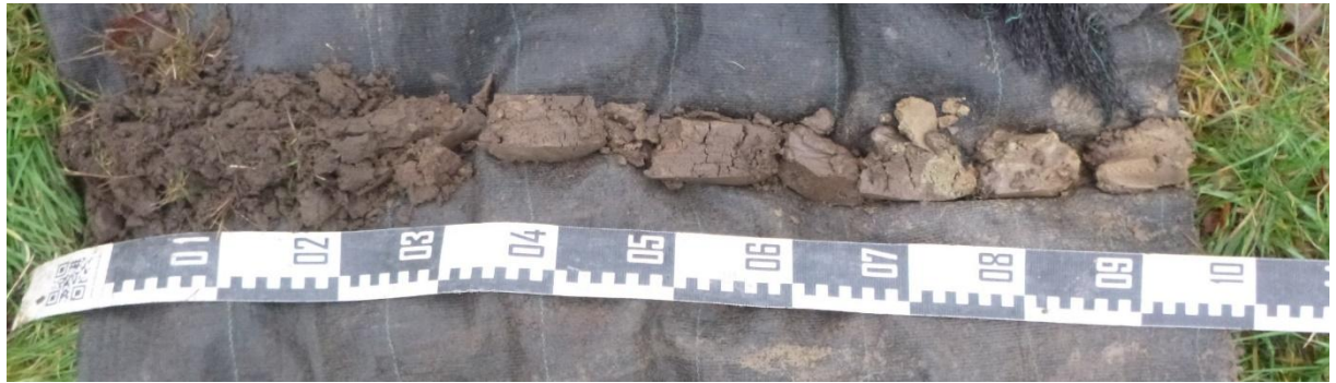
Figuur 18 Overzichtsfoto van boring BP4, uitgelegd van links naar rechts en van boven naar onder (overgenomen uit LBO-rapport 2022A431)
