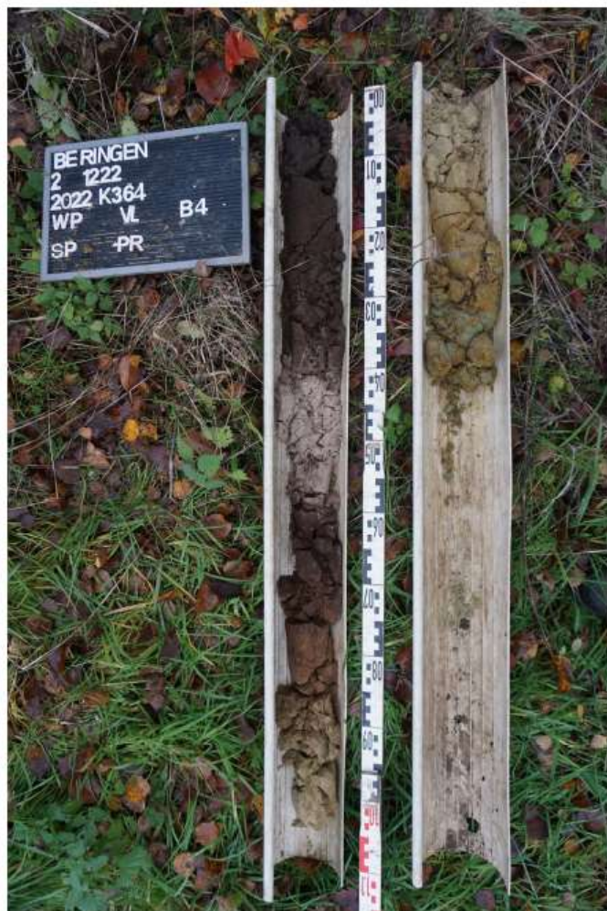
Fig. 2.14: Bodemprofiel 4 referentiebodemprofiel pedogenetische zone met Podzolbodem.
