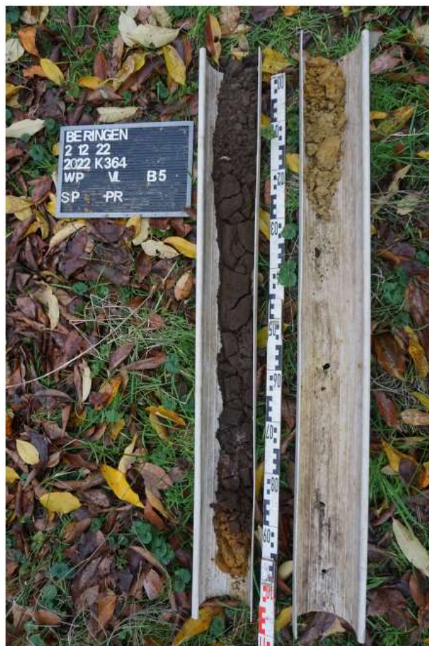
Fig. 2.13: Bodemprofiel 12, referentiebodemprofiel pedogenetische zone met A/C-profielen.
