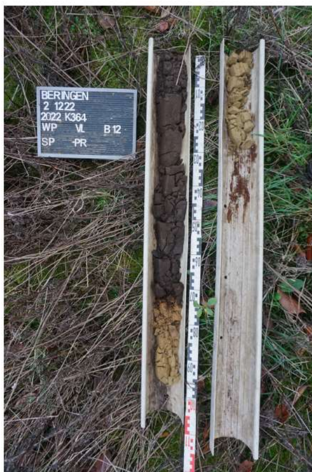
Fig. 2.12: Bodemprofiel 12, referentiebodemprofiel pedogenetische zone met A/C-profielen.
