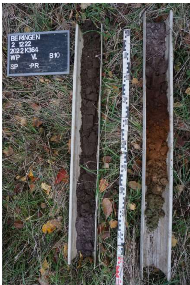
Fig. 2.15: Bodemprofiel 4 referentiebodemprofiel pedogenetische zone met Podzolbodem.
