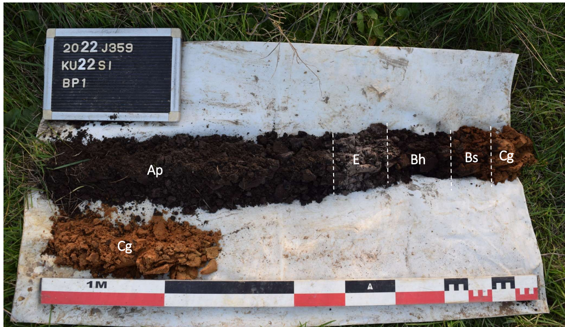
Afb.30: Referentieprofiel B1 met aanduiding van de horizonten Ap-E-Bh-Bs-Cg (Bron: Aron bv, dd. 02/11/2022, 2022J359).
