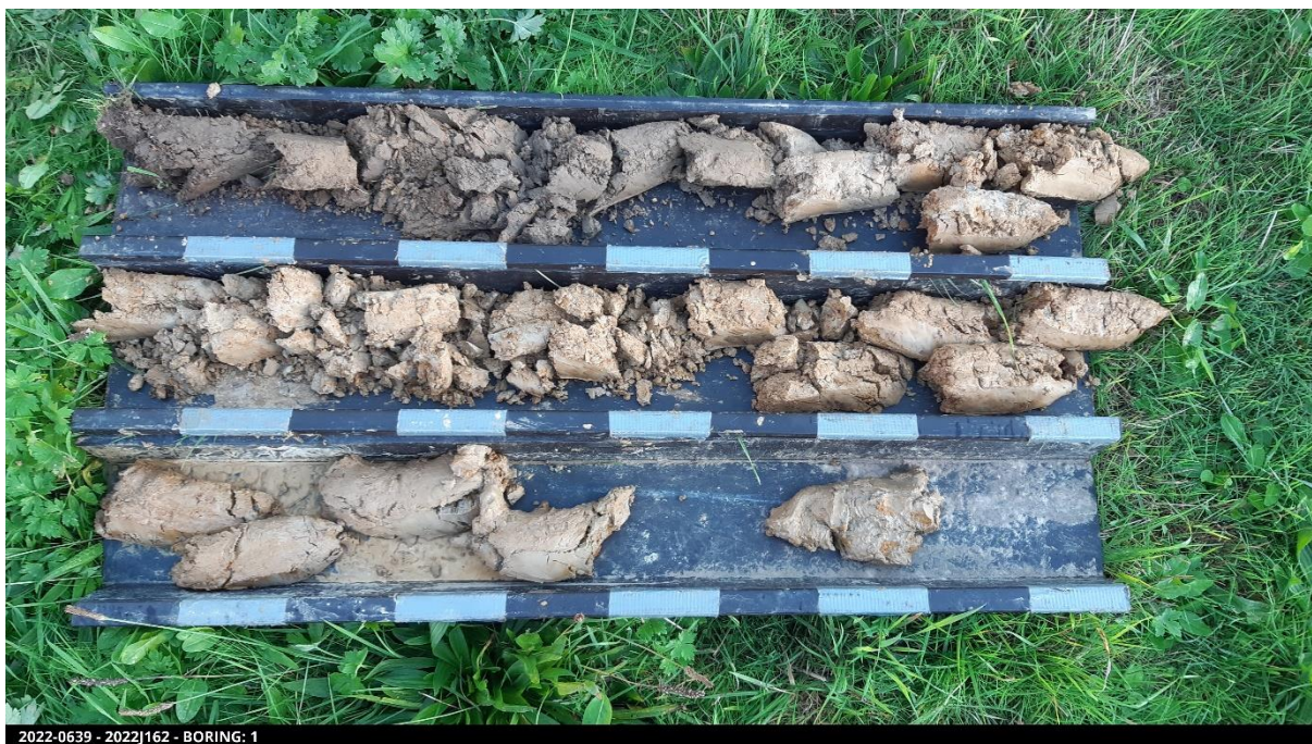
Figuur 6: Foto van boring 1 (elke boorgoot is 1 meter lang).
