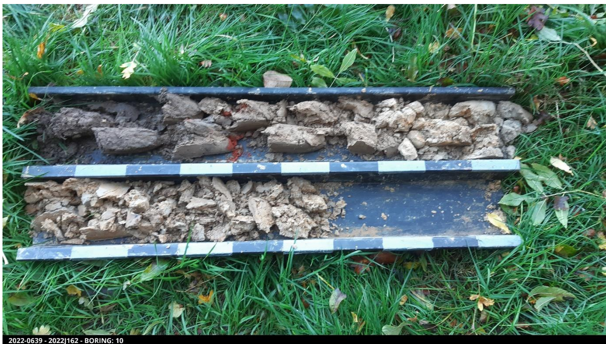
Figuur 7: Foto van boring 10 (elke boorgoot is 1 meter lang).
