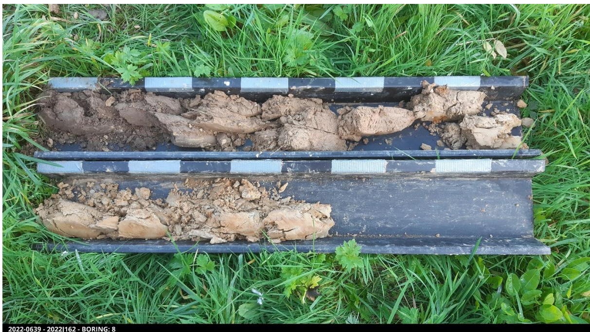
Figuur 9: Foto van boring 8 (elke boorgoot is 1 meter lang).
