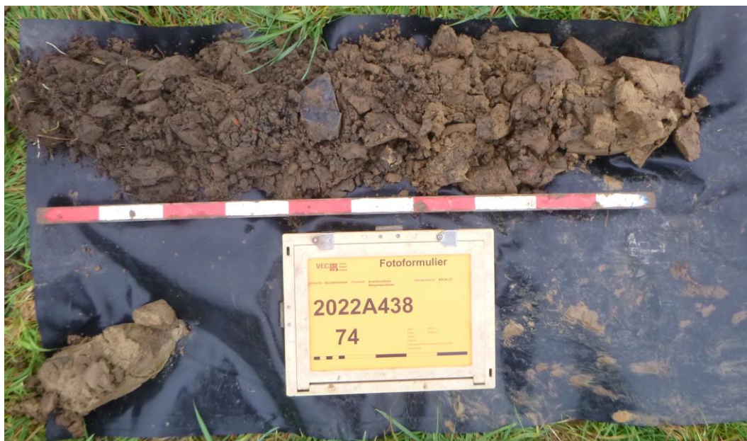
Afb. 32. Foto van boring 74, uitgelegd van links naar rechts; boven naar onder. 0-20 centimeter: Ap-horizont; 20-50 centimeter: Aa-horizont; 50-90 centimeter: A/C-horizont; 90-120 centimeter: C-horizont.
