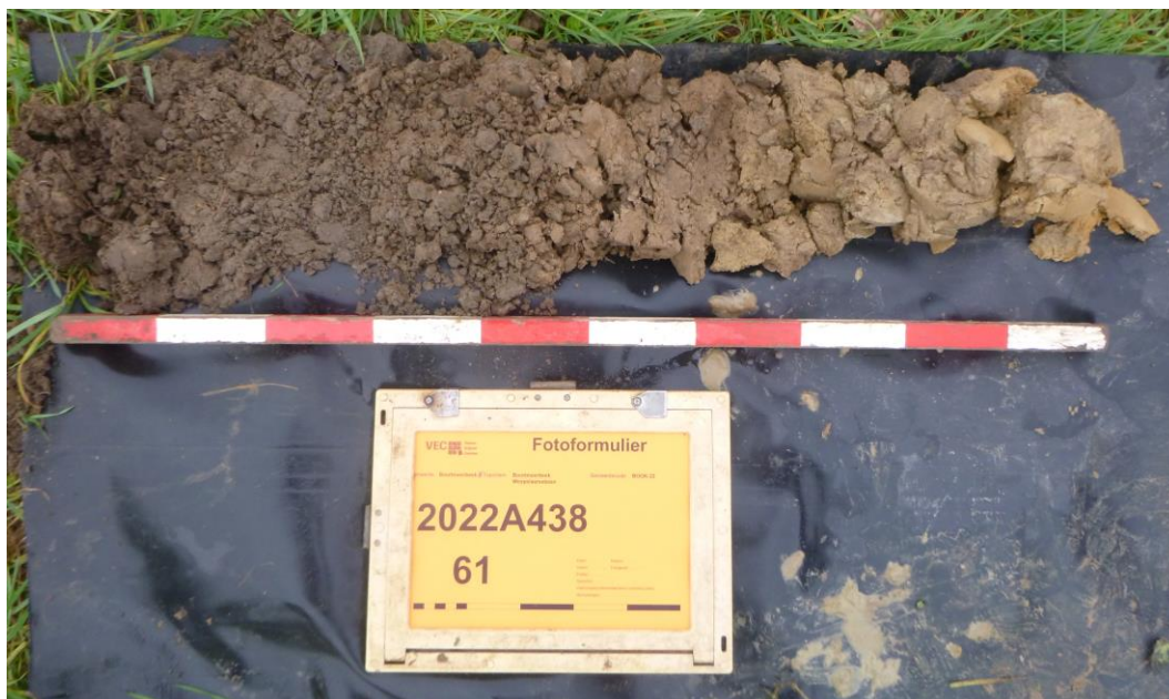
Afb. 31. Foto van boring 61, uitgelegd van links naar rechts. 0-10 centimeter: Ap-horizont; 10-40 centimeter: Aa-horizont; 40-70 centimeter: Bw-horizont; 70-100 centimeter: C-horizont.
