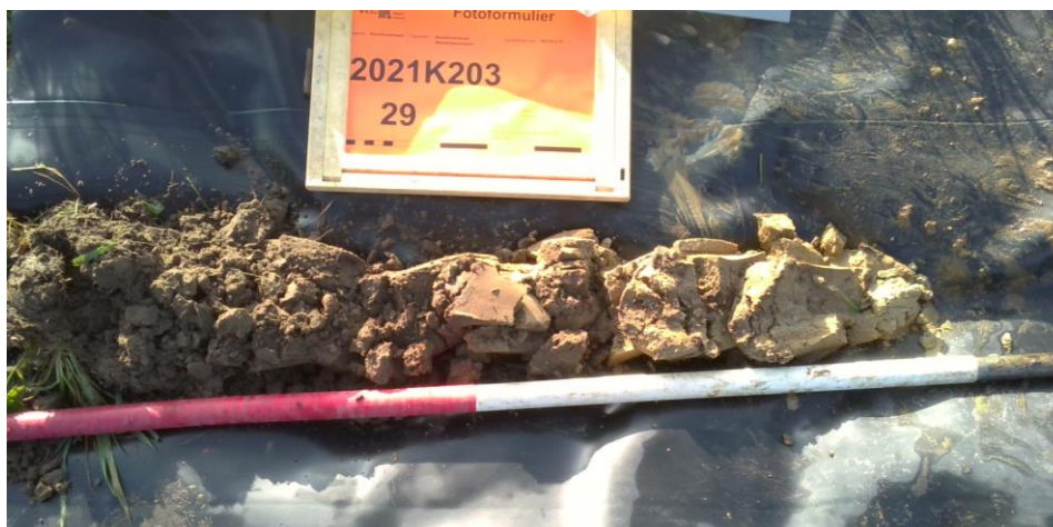
Afb. 24. Foto van boring 29, uitgelegd van links naar rechts. 0-10 centimeter: pakket 1; 10-45 centimeter: pakket 2; 45-100 centimeter: pakket 3.
