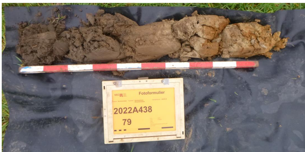
Afb. 30. Foto van boring 79, uitgelegd van links naar rechts. 0-30 centimeter: Ap-horizont; 30-60 centimeter: Bw-horizont; 60-100 centimeter: C-horizont.
