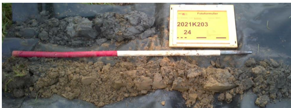
Afb. 22. Foto van boring24, uitgelegd van links naar rechts, onder naar boven. 0-20 centimeter: Ap-horizont; 20- 95 centimeter: Aa-horizont; 95-110 centimeter: Apb-horizont; 110 – 130 centimeter: Aab-horizont; 130 – 180 centimeter: C-horizont.
