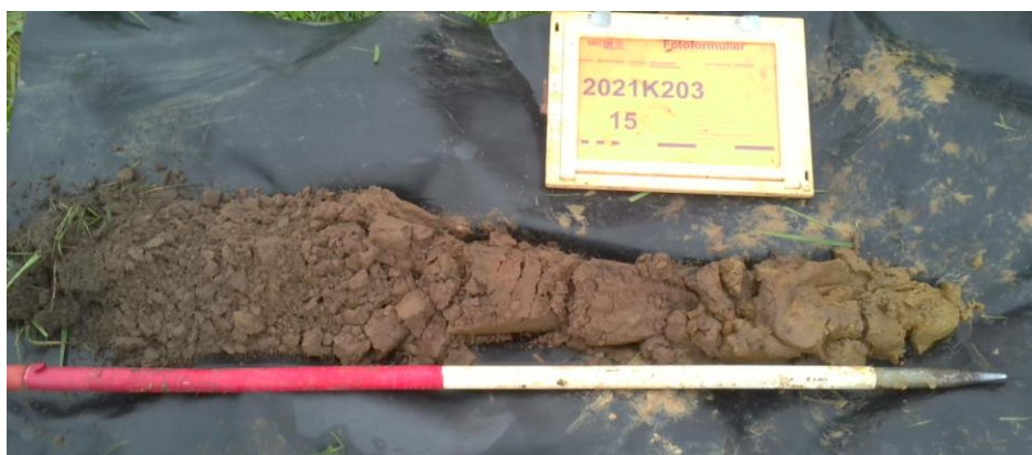
Afb. 23. Foto van boring 15, uitgelegd van links naar rechts. 0-15 centimeter: Ap-horizont; 15-60 centimeter: A(a)p-horizont; 60-75 centimeter: Bw-horizont; 75-100 centimeter: C-horizont.
