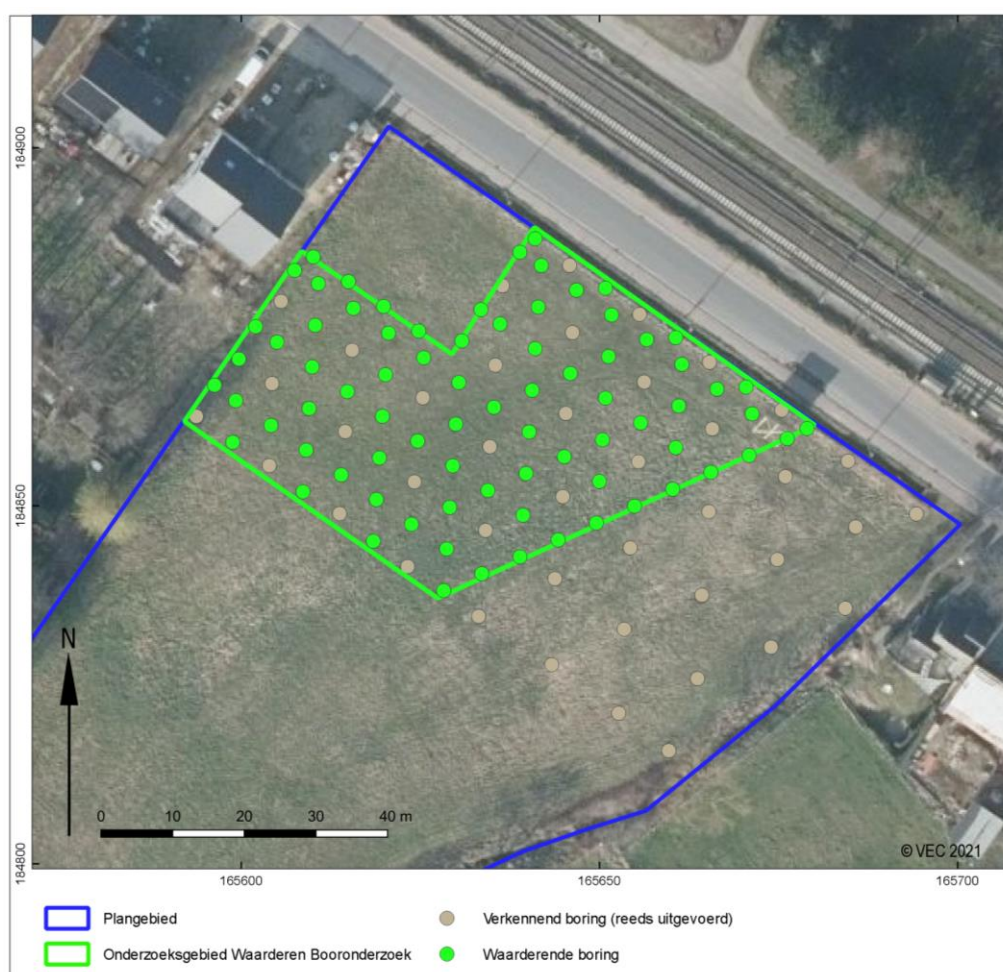
Afb. 27. Indicatief plan voor waarderende archeologische boringen ( n=78 ) in een 6 \times 5 m boorgrid (boorafstand \times raaiafstand), weergegeven op een luchtfoto uit 2020 (Luchtfoto Vlaanderen, winter 2020 – kleur). (Bron: Agentschap Informatie Vlaanderen)
